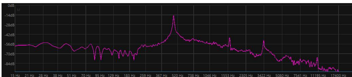
Obrázok 3.14 Frekvenčné spektrum, tón a# 1 bez piezoelektrického snímača
