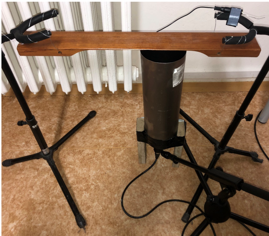
Obrázok 3.15 Meranie s rezonátorom, tón c^1 s nalepeným piezoelektrickým snímačom
