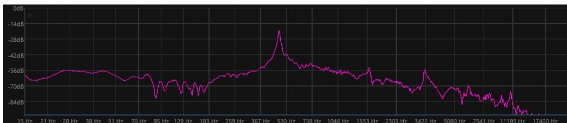
Obrázok 3.13 Frekvenčné spektrum, tón a# 1 s nalepeným piezoelektrickým snímačom
