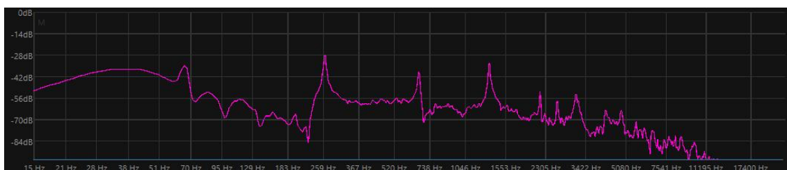
Obrázok 3.12 Frekvenčné spektrum, tón c^1 bez piezoelektrického snímača
