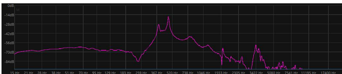
Obrázok 3.19 Frekvenčné spektrum s rezonátorom, tón a\#^1 bez piezoelektrického snímača
