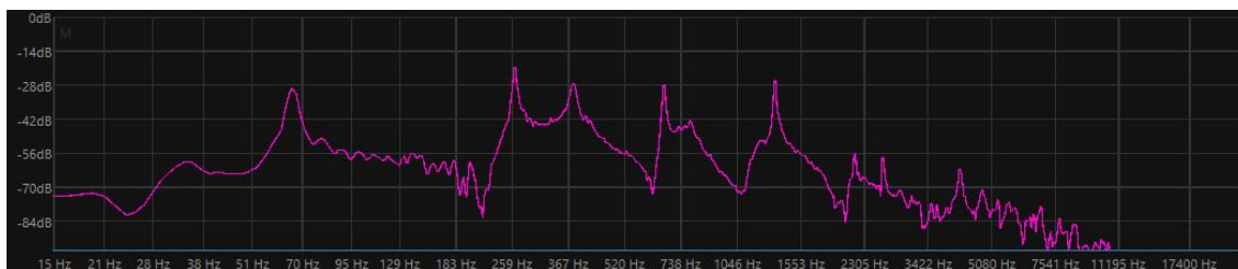
Obrázok 3.17 Frekvenčné spektrum s rezonátorom, tón c^1 bez piezoelektrického snímača
