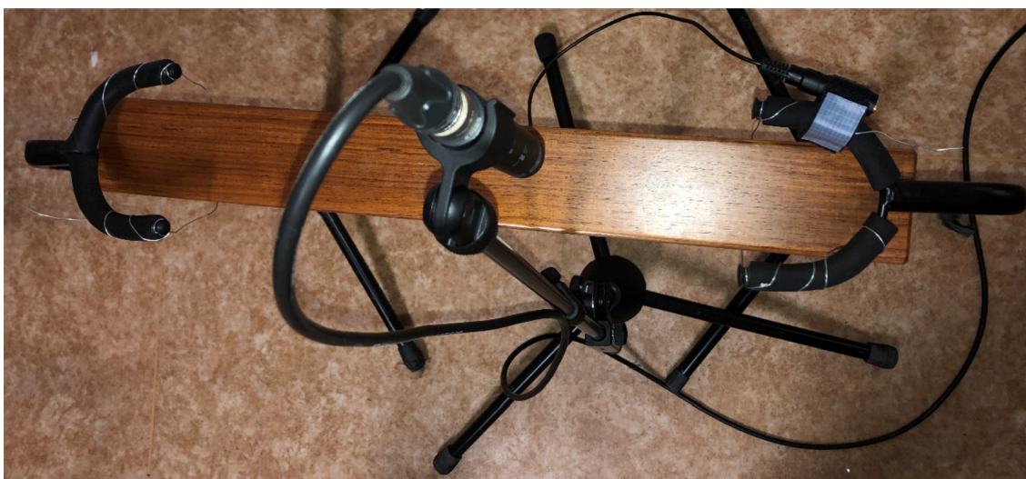
Obrázok 3.10 Meranie bez rezonátora, tón c^1 s nalepeným piezoelektrickým snímačom
