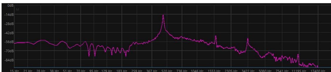
Obrázok 3.14 Frekvenčné spektrum, tón a# 1 bez piezoelektrického snímača
