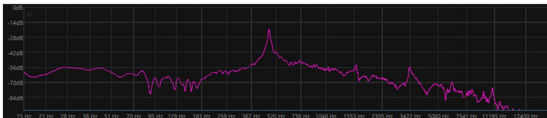
Obrázok 3.13 Frekvenčné spektrum, tón a# 1 s nalepeným piezoelektrickým snímačom
