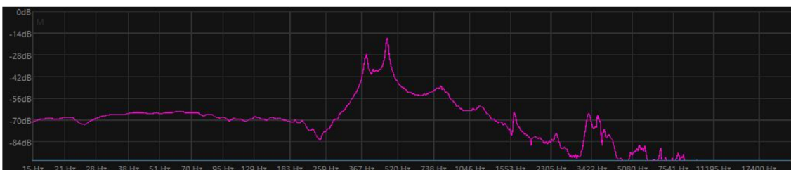
Obrázok 3.18 Frekvenčné spektrum s rezonátorom, tón a\#^1 s nalepeným piezoelektrickým snímačom
