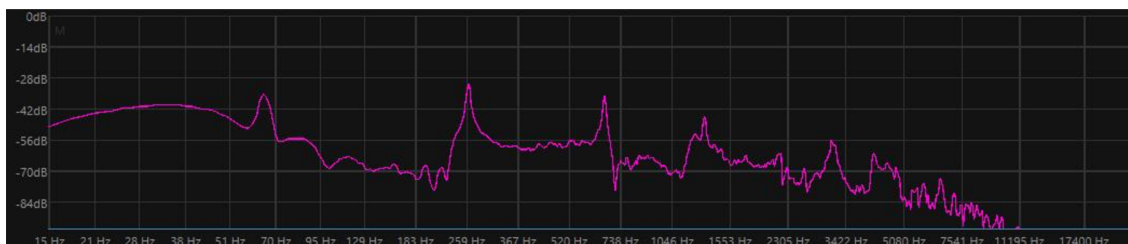
Obrázok 3.11 Frekvenčné spektrum, tón c^1 s nalepeným piezoelektrickým snímačom
