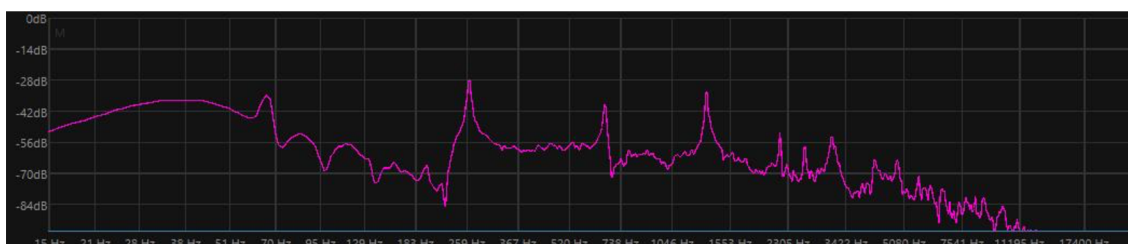
Obrázok 3.12 Frekvenčné spektrum, tón c^1 bez piezoelektrického snímača
