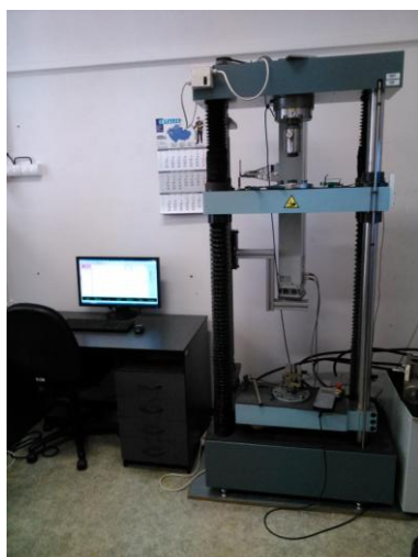
Obr. 10.8: Trhací zařízení s PC pro vyhodnocení
