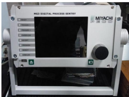
Obr. 9.2: Zařízení MIYACHI PECO MG3 pro monitorování svařovacího procesu.
