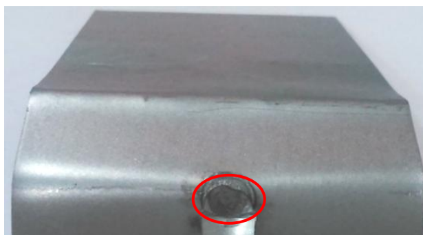
Obr. 11.10 ukázka svaru vzorku z experimentu 3
