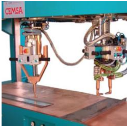
Obr. 3.9 d) Robot pro bodové svařování /12/
