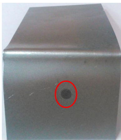
Obr. 11.13: Vzorek 2 pro odlupovací zkoušku (experiment 4).
