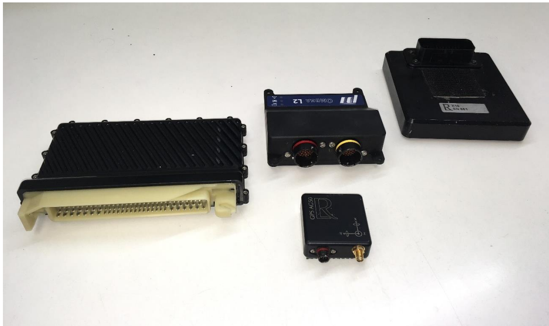
Obrázek 7 – zleva ECU Liferacing F88, datalogger Coswort Omega L2, Expansion box Liferacing X10, v popředí chassis modul Liferacing GPS-AG50
