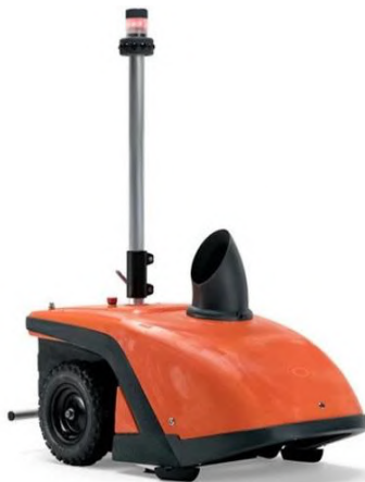
Obr. 13 Autonomní sněhová fréza SNOWBO [12]
