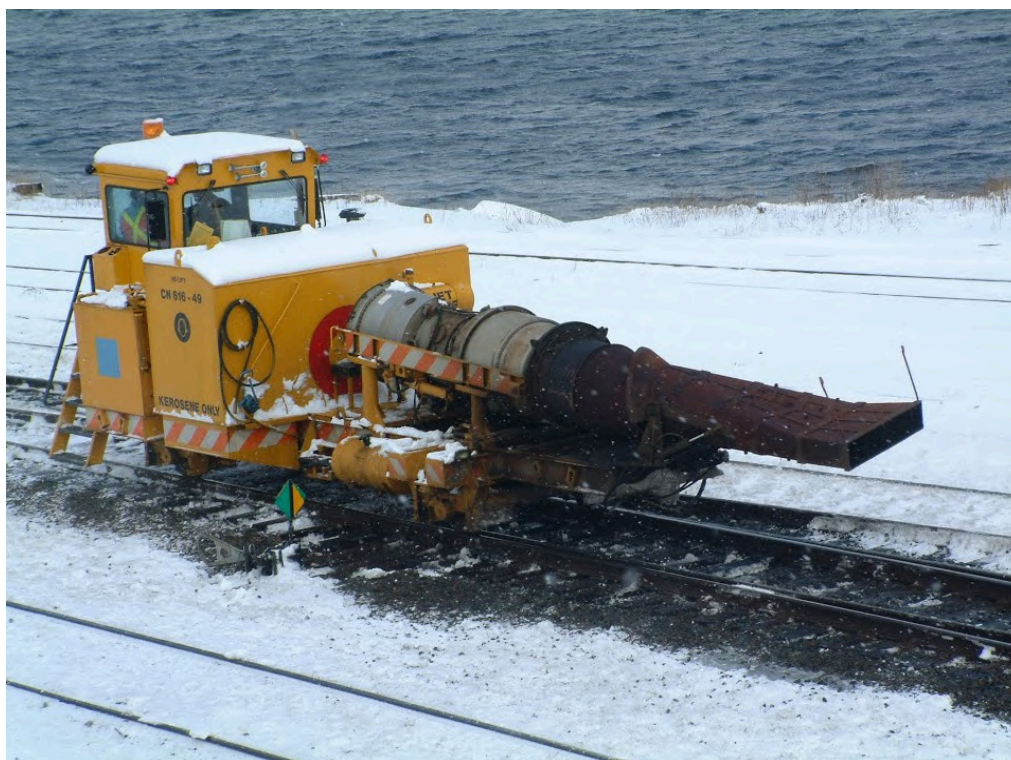
Obr. 6 Vlaková souprava s proudovým motorem CN 616-49 [4]
