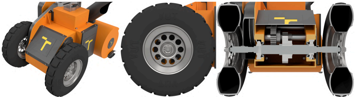
Obr. 30 Kola a náprava v řezu
