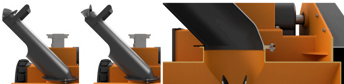
Obr. 24 Komín (bez deflektoru, s deflektorem, řez základny)
