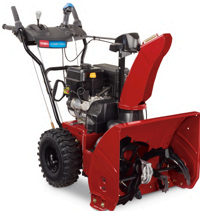
Obr. 1 Dvoustupňová benzínová sněhová fréza Power Max 826 OAE s průměrem 66 cm [2]
