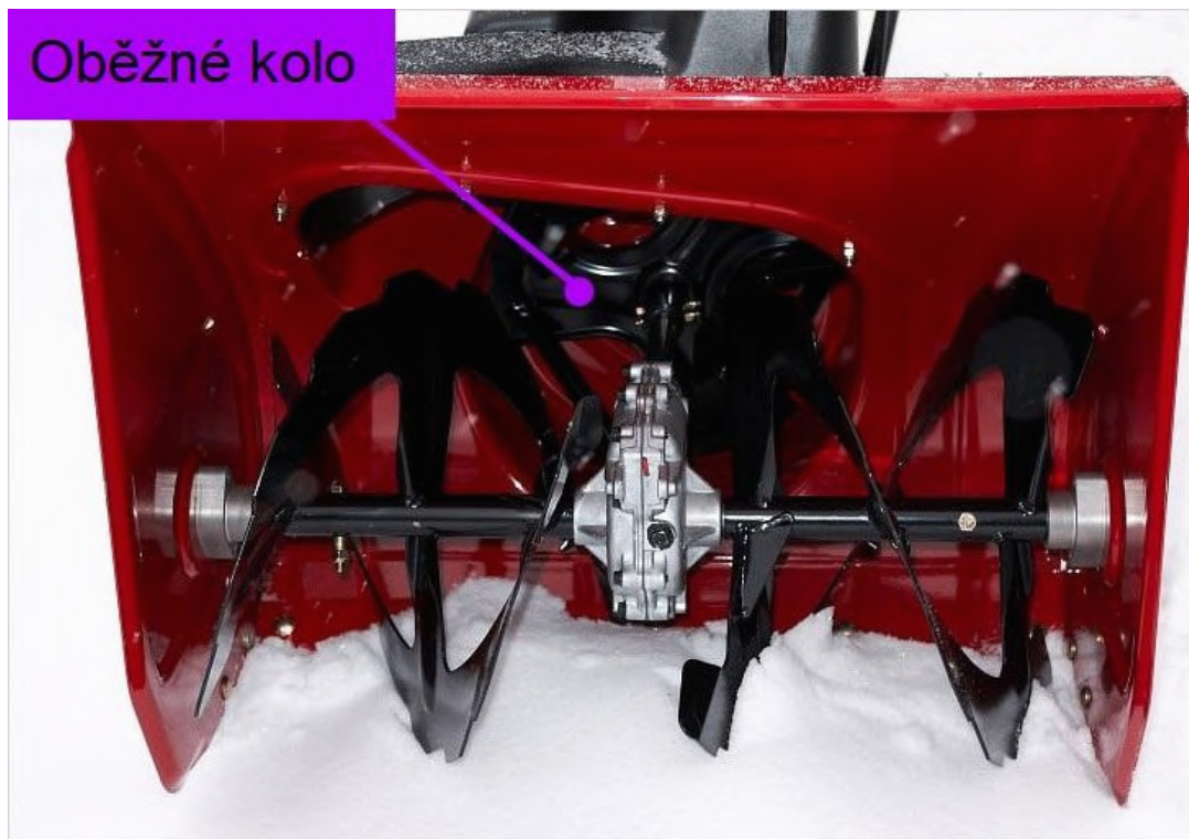
Obr. 3 Dvoustupňová sněhová fréza s výraznějším oběžným kolem [3]
