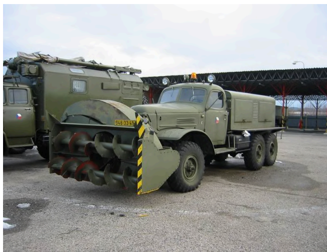
Obr. 7 Vozidlo zimní údržby ČSLA SOV - D-470 [5]
