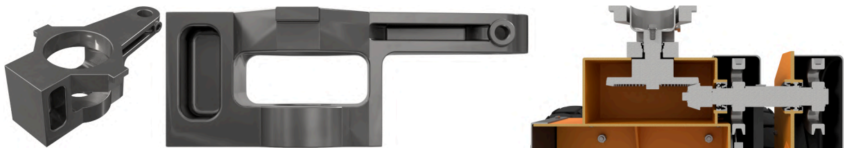
Obr. 27 Dosedací těleso a pohled v řezu na dosedací těleso s hřídelí řemenic
