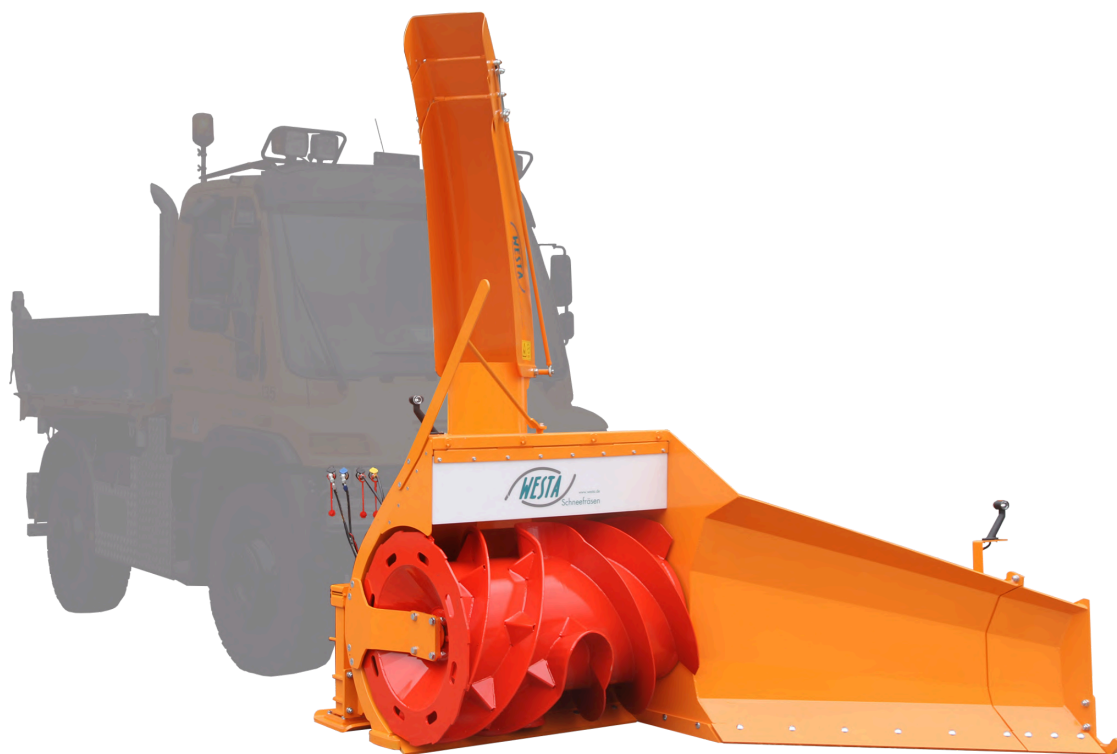
Obr. 8 Přídavná sněžná fréza pro vozidlo městské služby [6]
