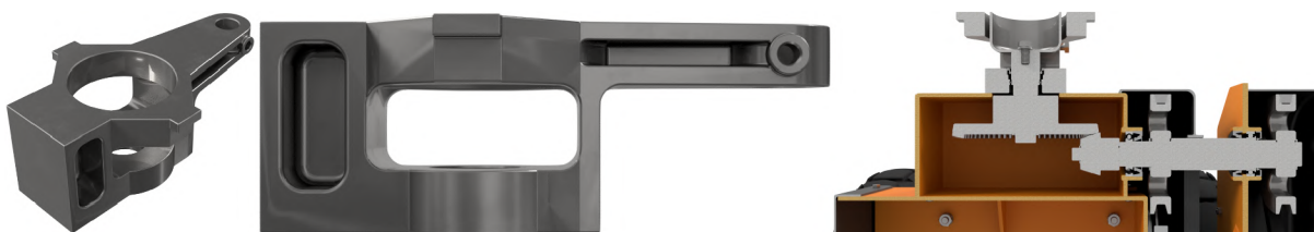
Obr. 27 Dosedací těleso a pohled v řezu na dosedací těleso s hřídeli řemenic
