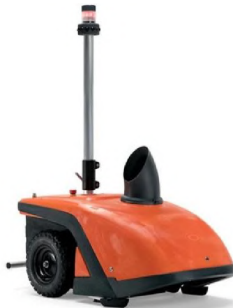
Obr. 13 Autonomní sněhová fréza SNOWBO [12]
