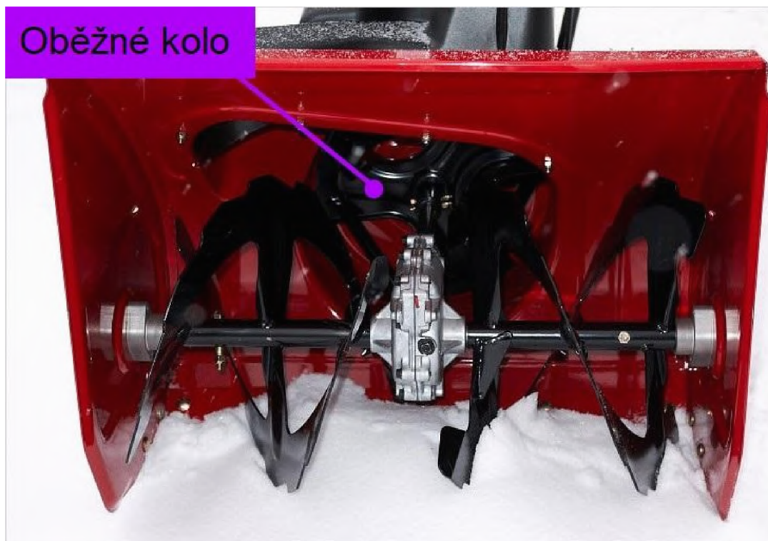
Obr. 3 Dvoustupňová sněhová fréza s výraznějším oběžným kolem [3]
