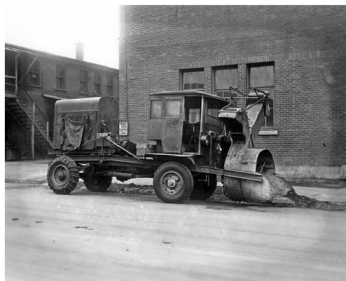
Obr. 17 Sicardova sněžná fréza z třicátých let dvacátého století ve městě Montreal [13]
