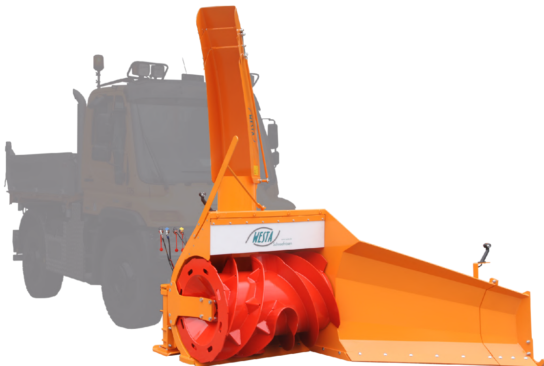
Obr. 8 Přídavná sněžná fréza pro vozidlo městské služby [6]
