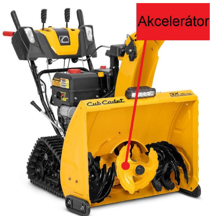
Obr. 4 Třístupňová sněhová fréza s výraznějším akcelerátorem [22]
