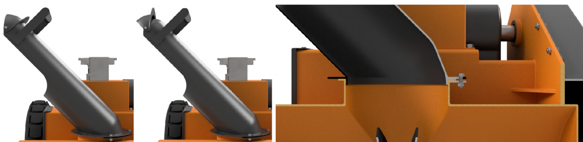
Obr. 24 Komín (bez deflektoru, s deflektorem, řez základny)
