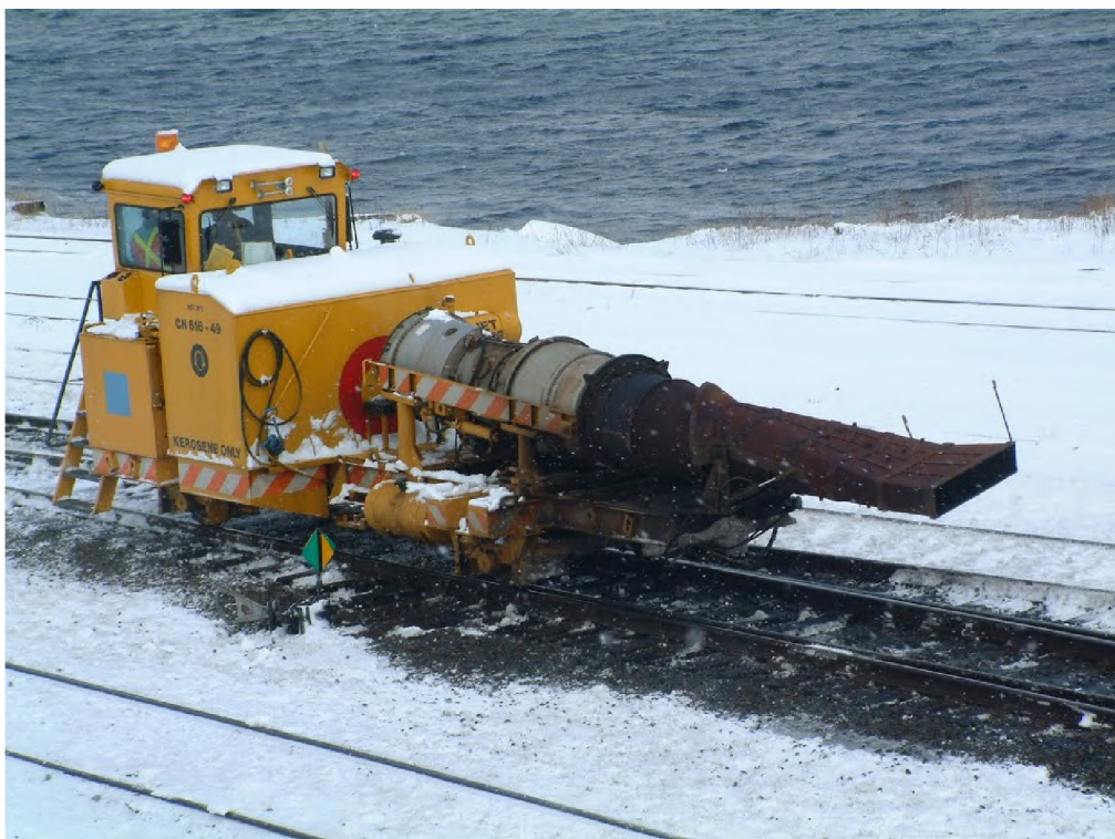
Obr. 6 Vlaková souprava s proudovým motorem CN 616-49 [4]
