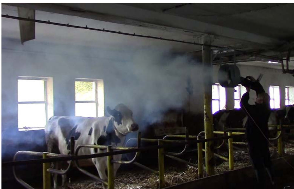
Obr. 24: Průběh kouřové zkoušky po nainstalování ventilátoru
