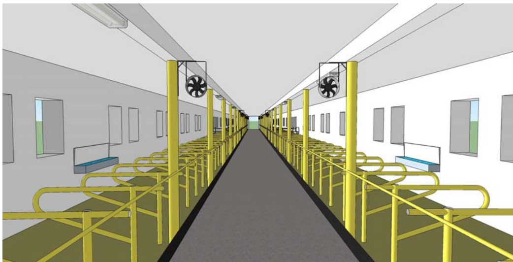
Obr. 25: Situační plán s návrhem rozmístění ventilátorů
