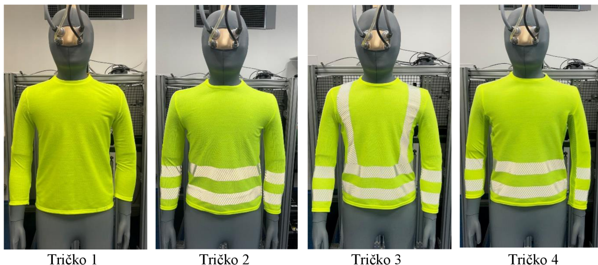
Obrázek 41. Fotografie triček na tepelném manekýnu
