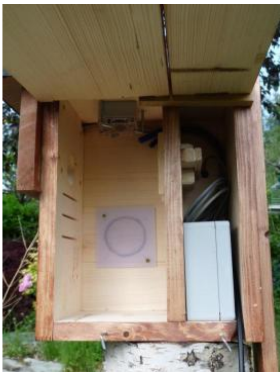
Obrázek 12. Vnitřní uspořádání chytré ptačí budky (Foto: VLASTIMIL OSOBA, 2016).
