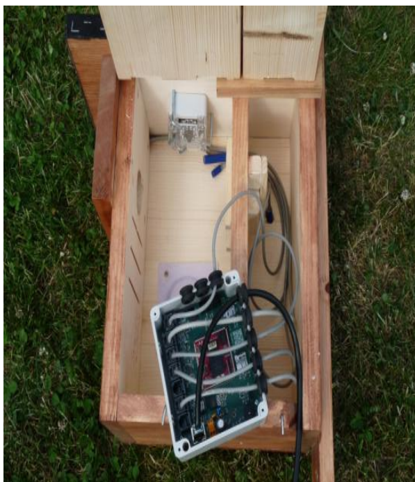
Obrázek 13. Integrovaná řídicí jednotka v plastovém boxu (Foto: VLASTIMIL OSOBA, 2016).
