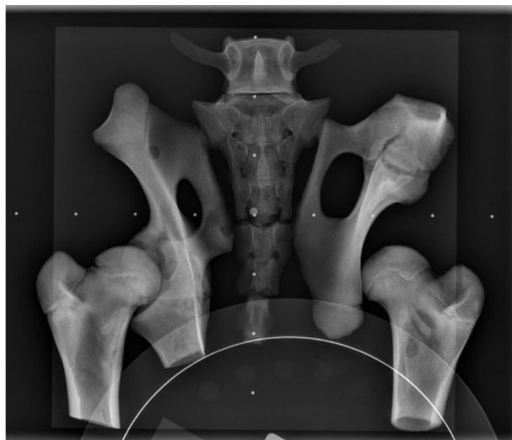
Obrázek 12 Umístění komory DAPcheck a fantomu FL18 na fantom pánve
