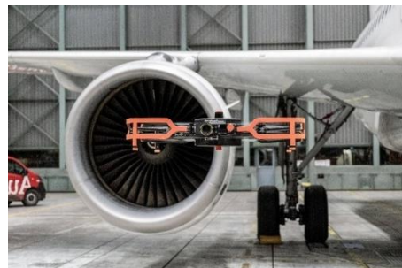
Obr. 3: Inspekce letounu dronem [11]
