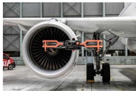
Obr. 3: Inspekce letounu dronem [11]
