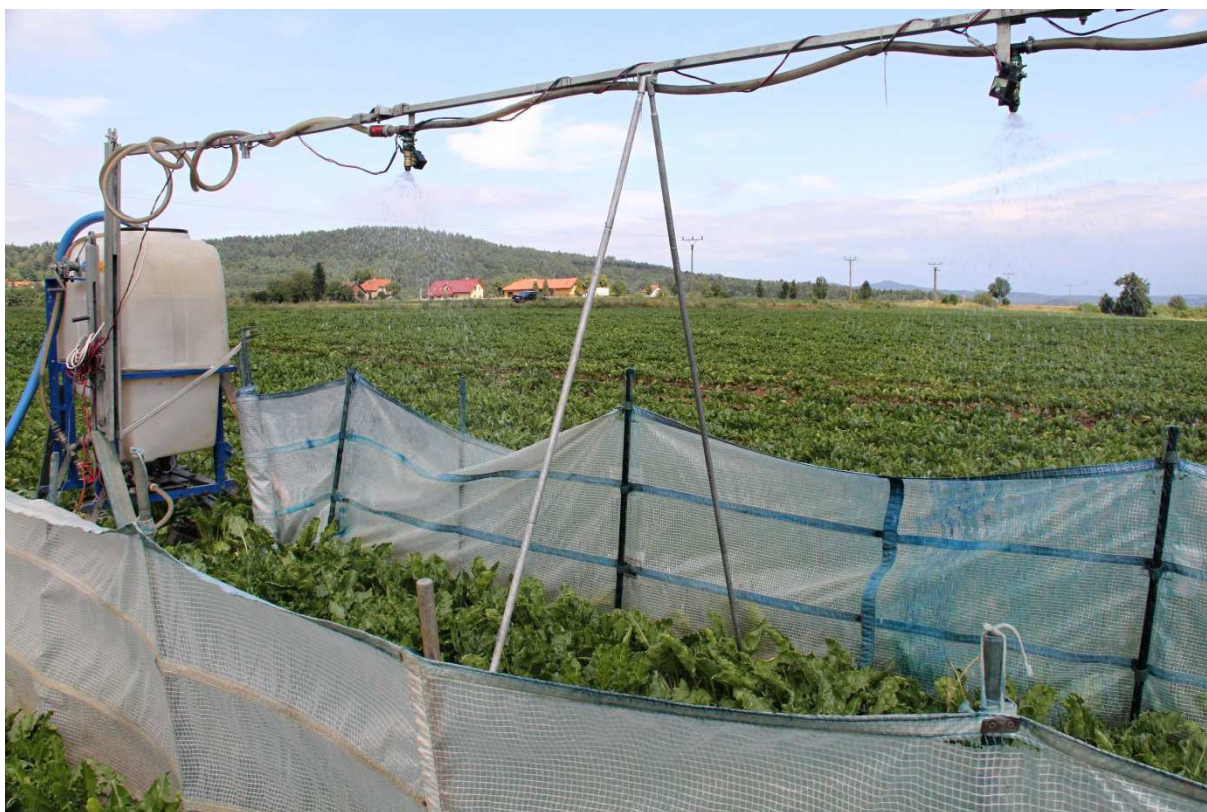
Obrázek č. 2 - Polní simulátor deště
