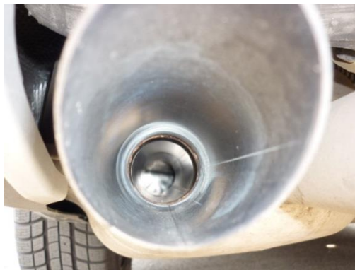
Obr. 12. Koncovka výfuku s funkčním DPF (ujeto cca 87 000 km) [16]
