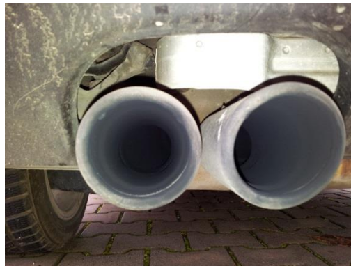
Obr. 11. Koncovka výfuku s odstraněným či poškozeným DPF [16]
