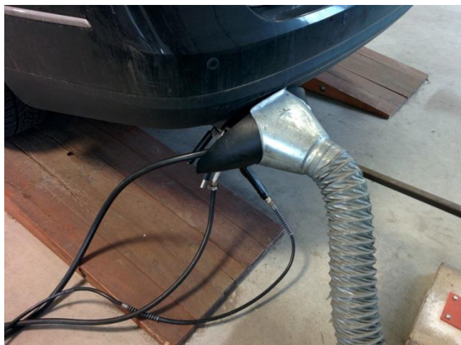
Obr. 13. Umístění všech měřicích sond ve výfukovém potrubí
