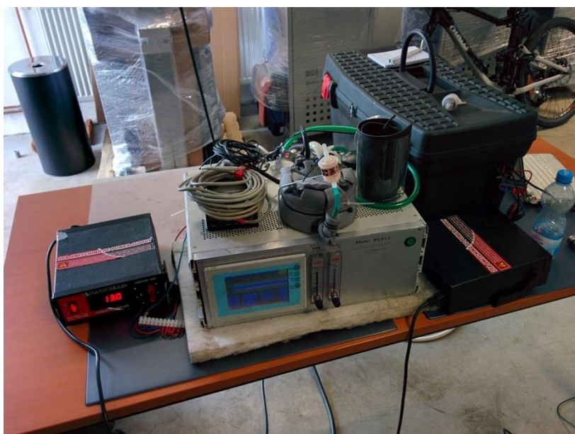
Obr. 10. Kompletní zařízení pro měření částic a koncentrací plynů
