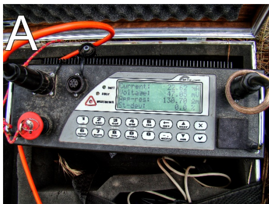
Obr. 8 Hlavní měřicí jednotka ARES (A) a válečková elektroda jako součást multielektrodového kabelu (B).
