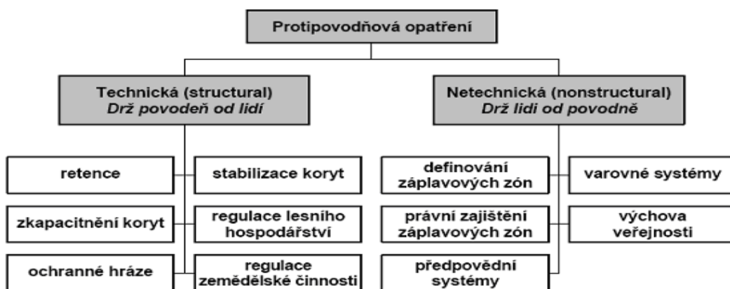
Obrázek 1: Schéma rozdělení protipovodňových opatření na technická a netechnická (cspovodne.eu)
