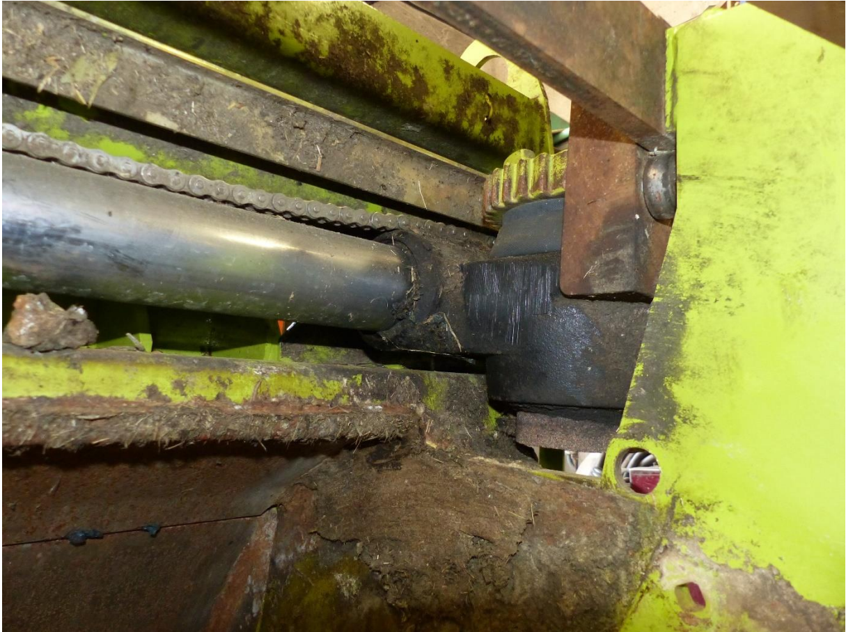
Obr. 12 Pohled na brusné zařízení (demontovaný řezací buben)
