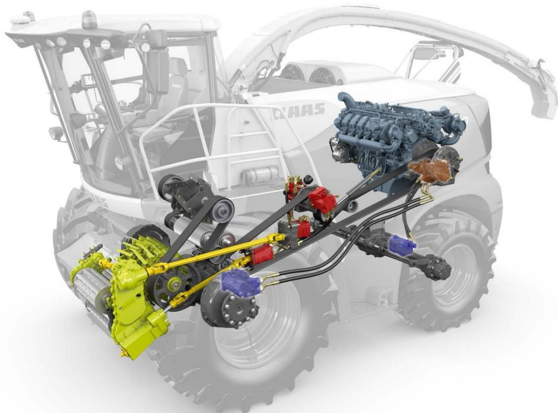
Obr. 2 Schéma pracovních částí sklízecí řezačky [3]
