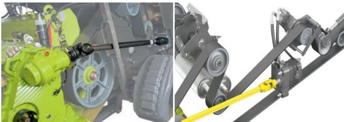
Obr. 4 Způsob pohonu, hydrostatická jednotka COMFORT CUT, [3]
