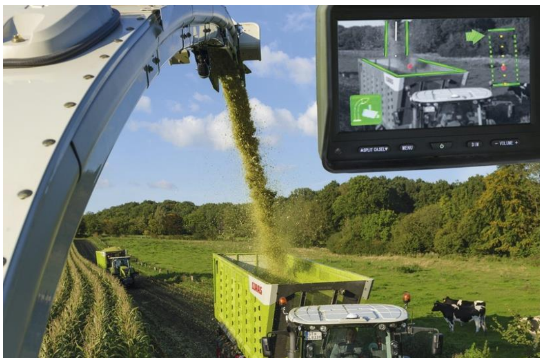
Obr. 17 Monitor systému AUTOFILL, odhozový komín [11]
