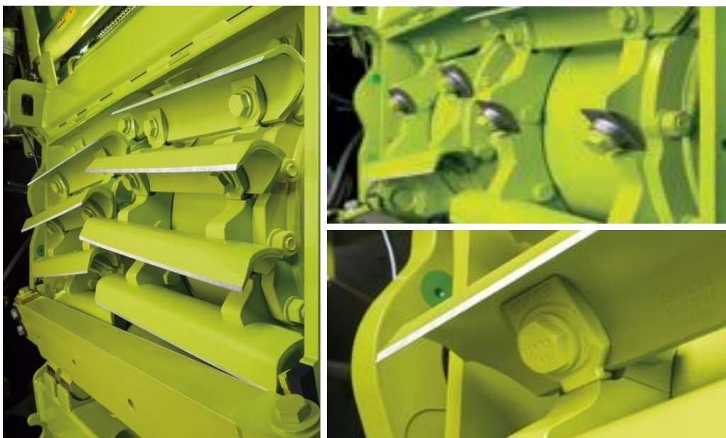
Obr. 8 Nožový buben V-MAX, použití polovičního počtu nožů, speciální podložka [6]
