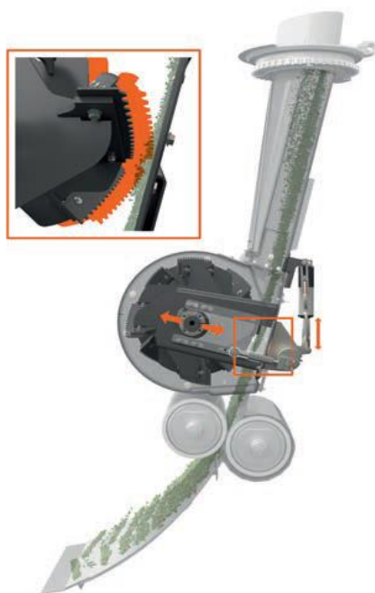
Obr. 16 Nastavení mezery metacího ústrojí Claas [6]
