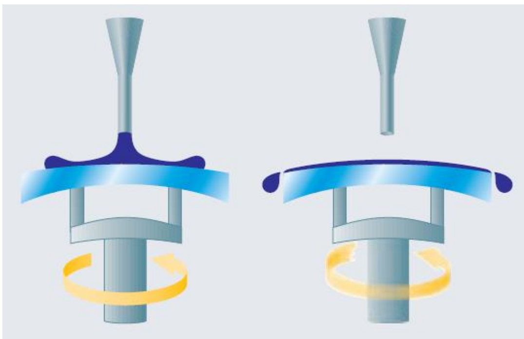
Obrázek 2: Metoda spin coating
