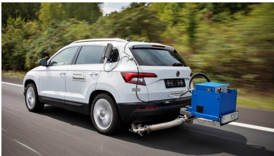
Obrázek č. 1 -Přístroj PEMS upevněný na vozidle značky ŠKODA AUTO a.s.
