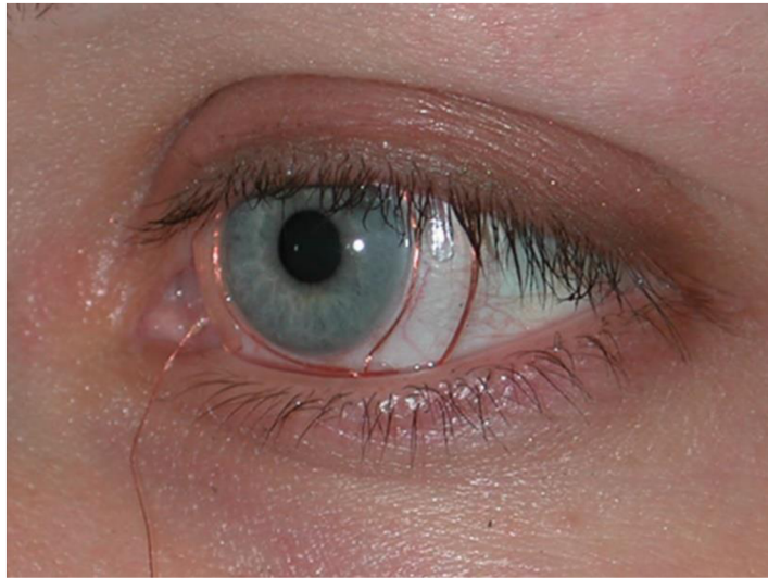
Obrázek 12: Kontaktní čočka s drátěnou cívkou (Zdroj: [25])
