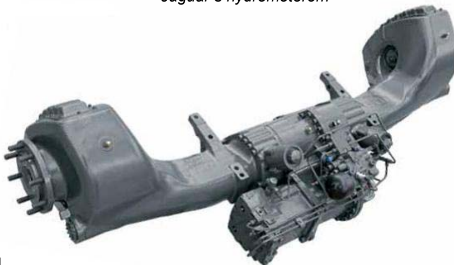
Obr. 20 Portálová přední náprava Claas Jaguar s hydromotorem
