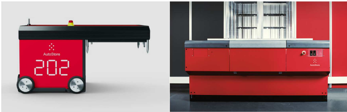
Obr. 4.7 Robot AutoStore a pickovacia stanica AutoStore
