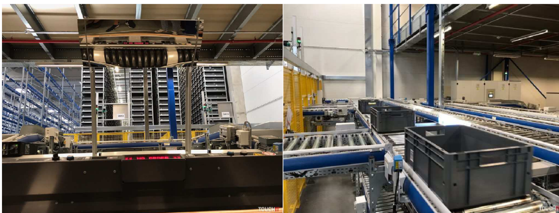
Obr. 4.2 Pickovacia stanica PTT z automatizovaného skladu SMC
