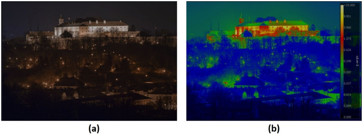
Obr. 4 (a) – fotografie pořízená digitálním fotoaparátem (b) – softwarově upravený snímek zobrazující jasovou mapu snímku [5]
