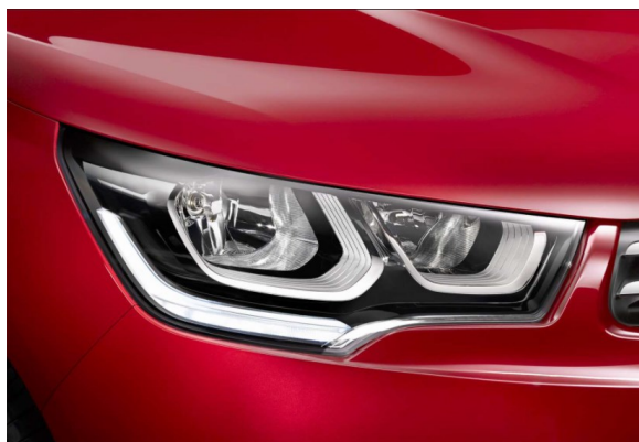
Obr. 14 Halogenový světlomet vozidla Citroen C4 druhé generace [18]
