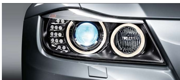
Obr. 16 Xenonový světlomet vozidla BMW 3. řady [18]
