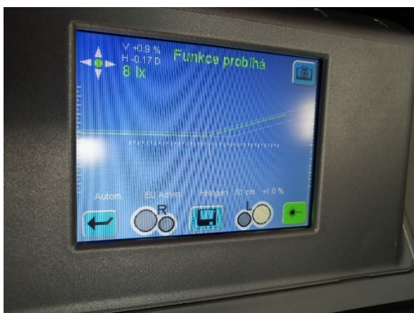
Obr. 42 Seřízení levého předního potkávacího světla regloskopem [Vlastní]
