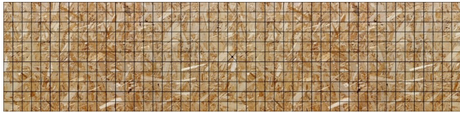
Obr. 46 Textura OSB desky po přidání rastru a s pomocným bodem označující střed [29]
