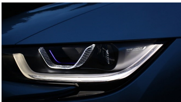
Obr. 20 Laserové světlomety vozidla BMW [18]
