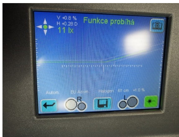
Obr. 43 Seřízení pravého předního potkávacího světla regloskopem [Vlastní]
