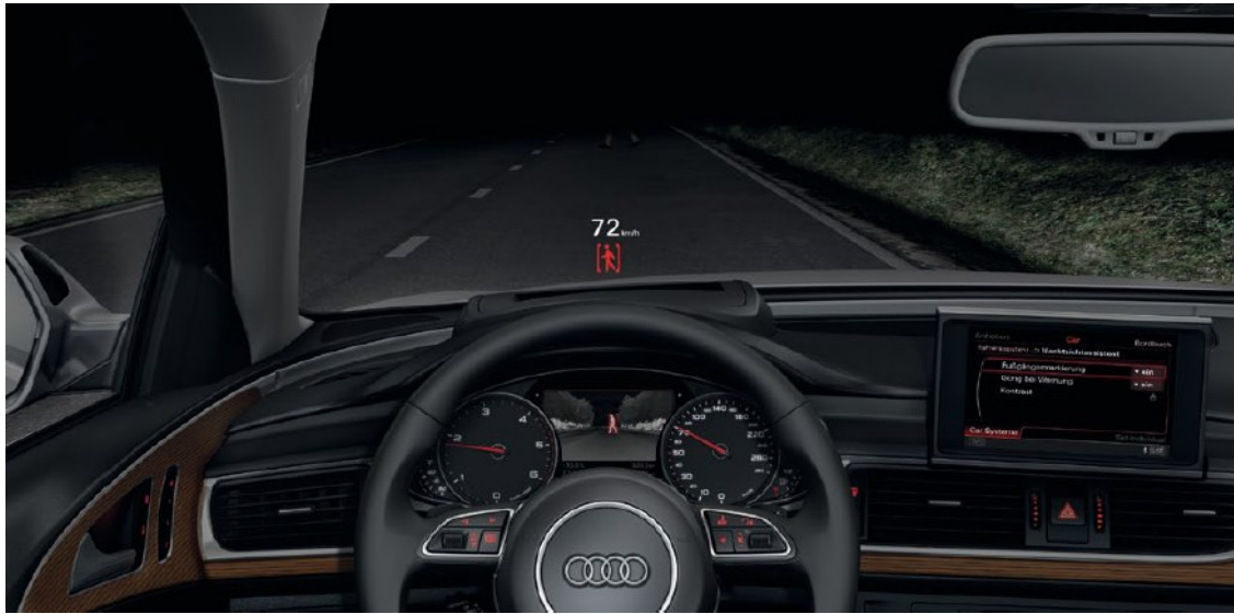
Obr. 25 Zobrazení možné srážky s chodcem na head-up displeji [20]
