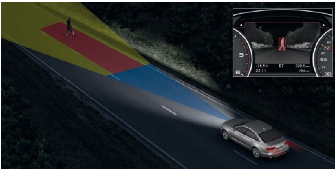
Obr. 26 Zvýraznění chodce nebo zvěře usměrněnými světlomety vozidla [20]
