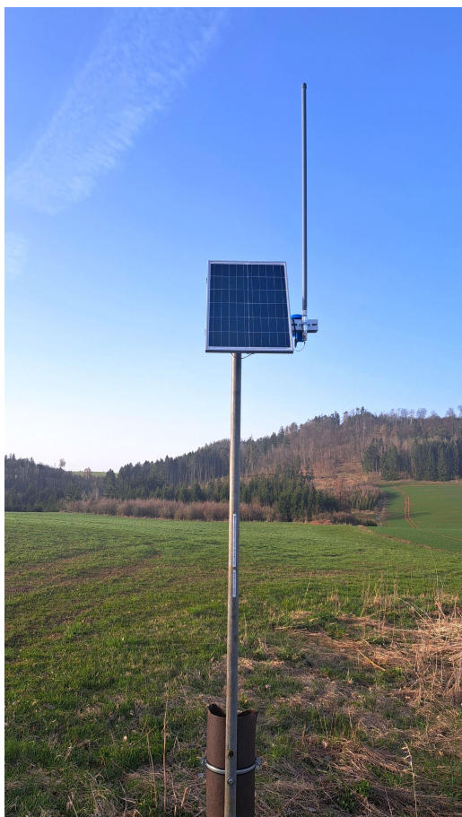
Obrázek 5.10: Jednotka určená do vzdálených míst (vlevo) a jednotka pro testování dosahu: Ještěd (1012 m n. m.)
