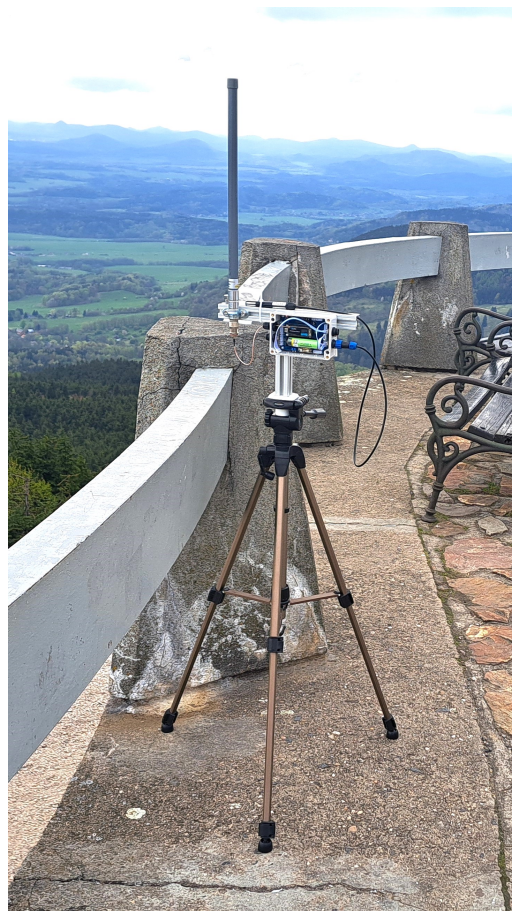
Obrázek 5.10: Jednotka určená do vzdálených míst (vlevo) a jednotka pro testování dosahu: Ještěd (1012 m n. m.)
