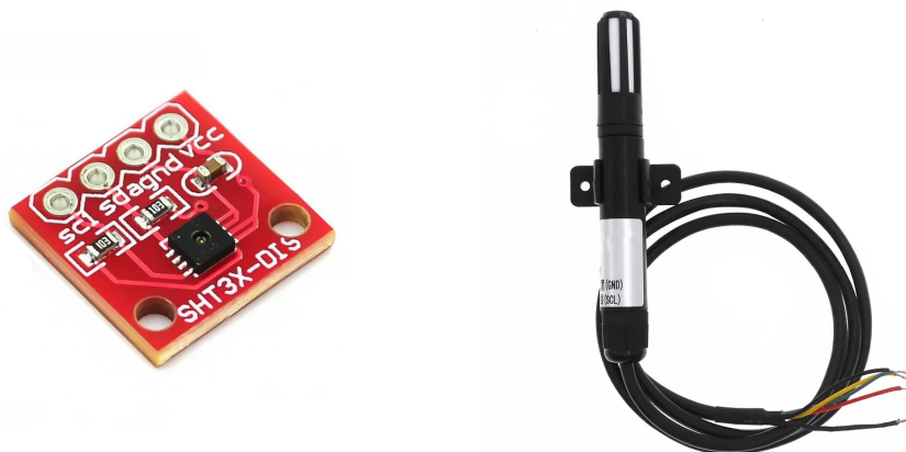
Obrázek 4.2: Senzory teploty a vlhkosti SHT31 – vlevo zabudovatelný modul DPS, vpravo ve vodotěsném pouzdře [29, 30]
