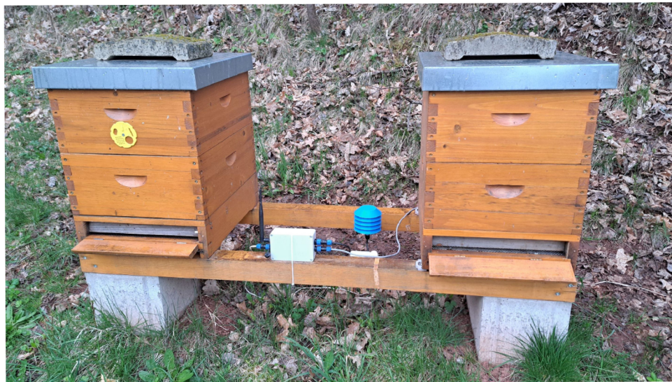
Obrázek 6.1: Sestava pro monitorování hmotnosti včelích úlů – celkový pohled
