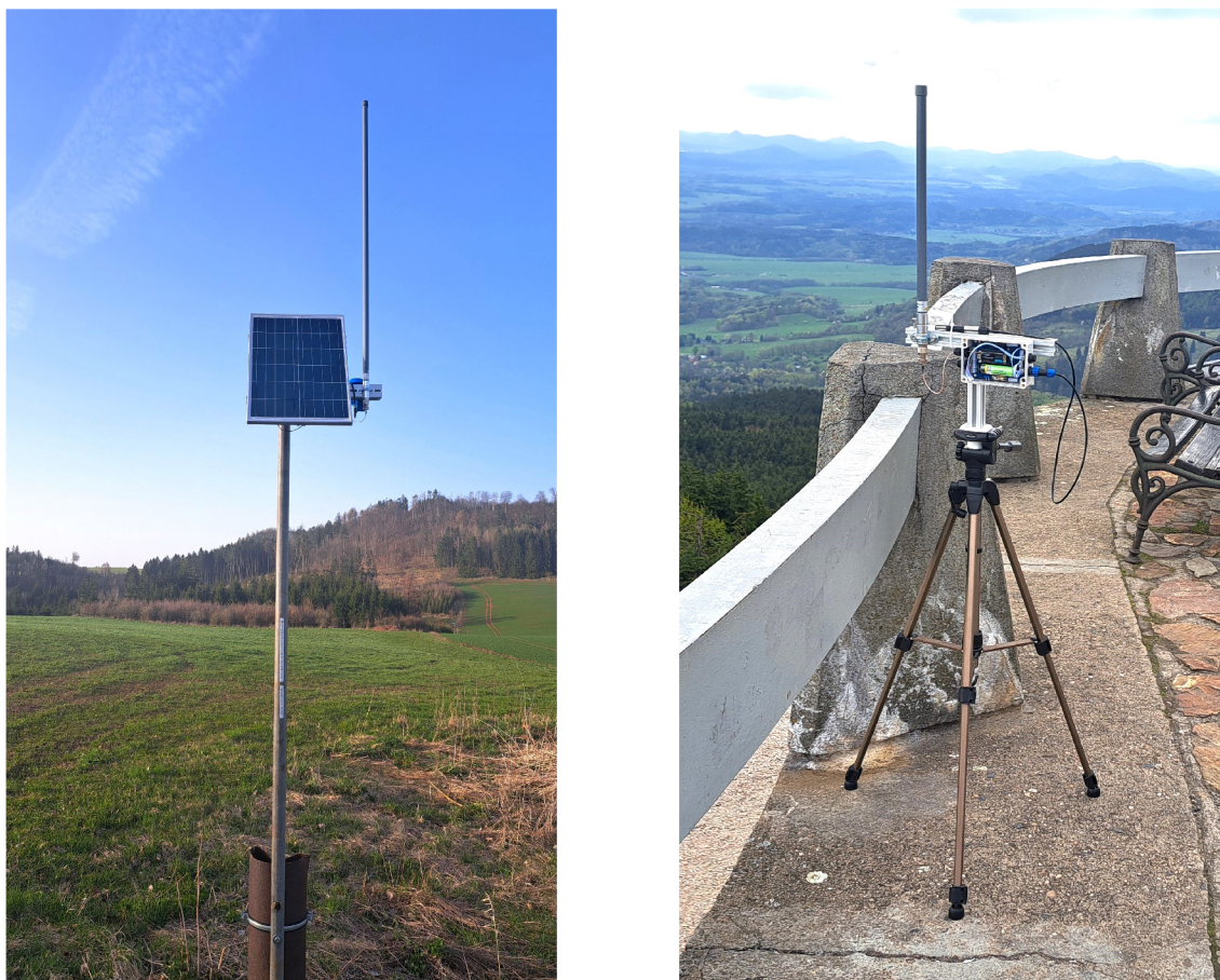
Obrázek 5.10: Jednotka určená do vzdálených míst (vlevo) a jednotka pro testování dosahu: Ještěd (1012 m n. m.)
