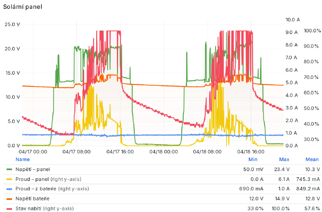
Obrázek 6.5: Zaznamenaný dvoudenní průběh parametrů fotovoltaické elektrárny
