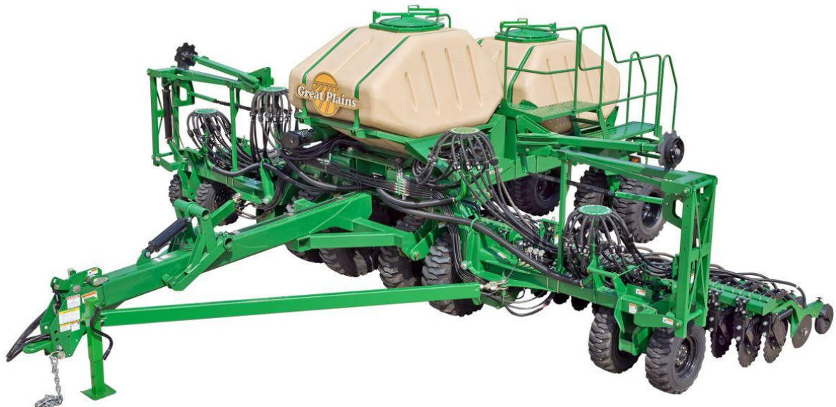
Obr. 23 Secí stroj pro přímé setí do strniště.
