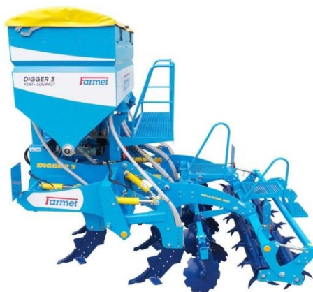
Obr. 21 Zásobník hnojiva umístěný nad strojem
