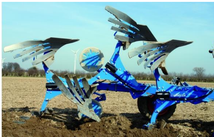
Obr. 12 hydraulické jištění orebního tělesa
