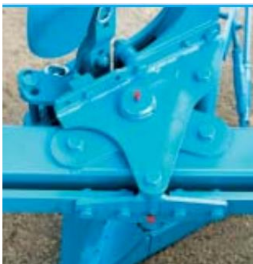
Obr. 13 uložení orebního tělesa, při vario provedení
