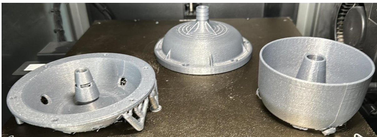
Obrázek 42: Výroba součástí prototypu na FDM 3D tiskárně
