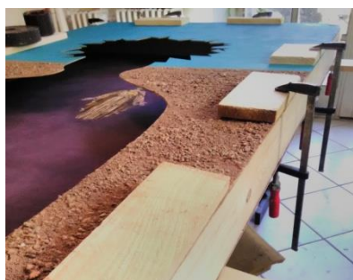
Obr. 29: lepení vrchní desky
