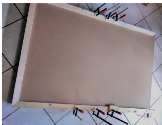
Obr. 15: zadní rám pro zpevnění celé konstrukce boxu
