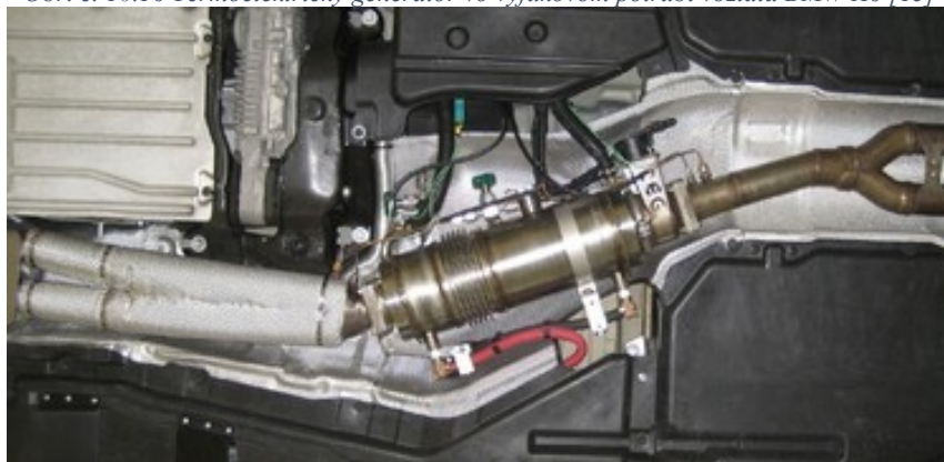
Obr. č. 10.16 Termoelektrický generátor vo výfukovom potrubí vozidla BMW X6 [15]
