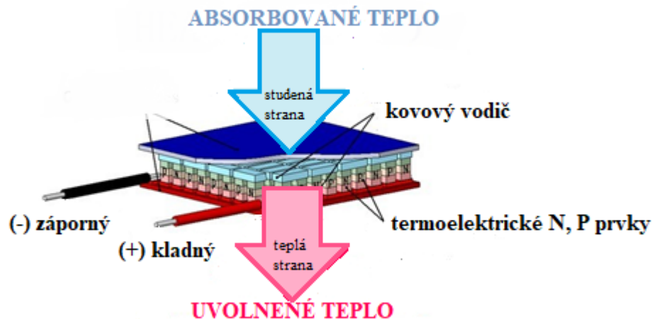
Obr. č. 10.2 Princíp termoelektrického modulu TEC [12]
