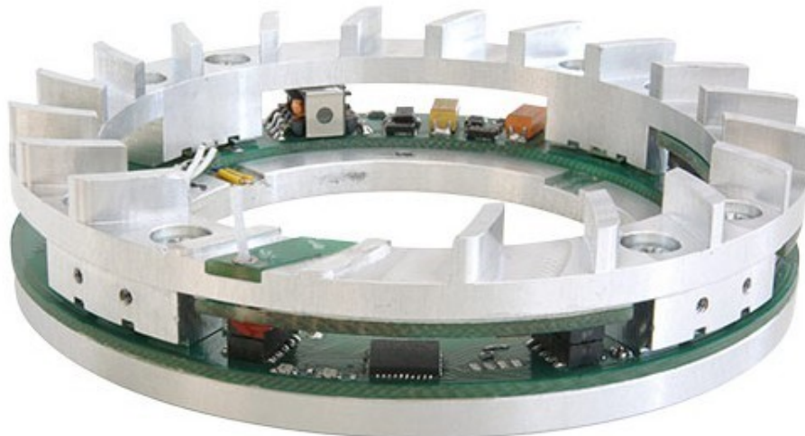
Obr. č. 10.19 Bezdrátový monitorovací systém [15]
