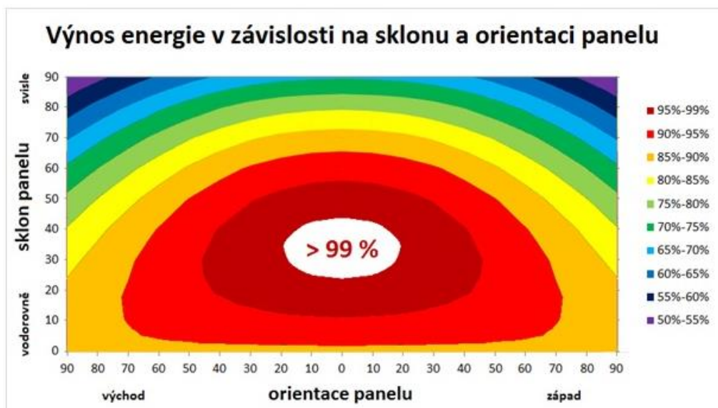
Obr. 2 Výnos energie v závislosti na sklonu a orientaci panelu[2]
