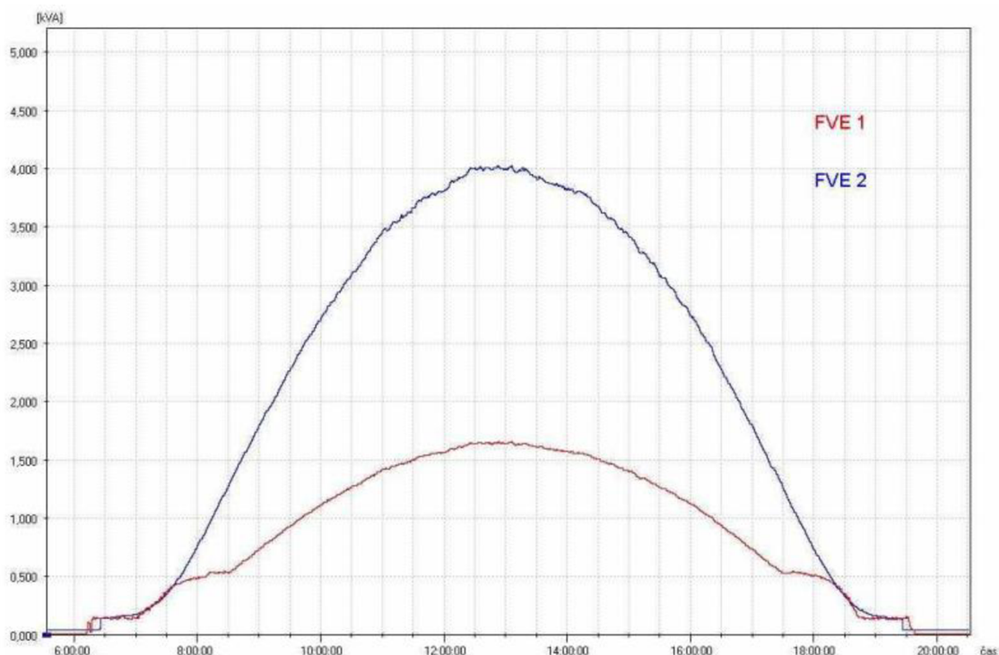
Obr. 15 Reálné měření generované el. energie na střeše rodinného domu[18]
