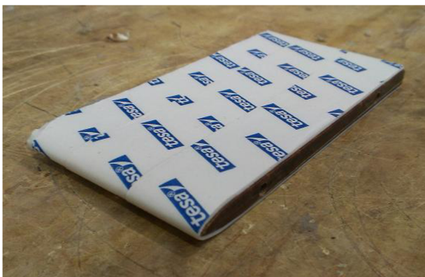
Obrázek 40: Nanesená lepicí páska na vzorku, zdroj: autor
