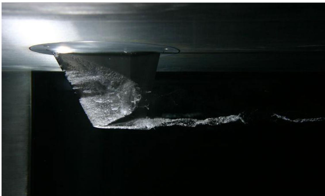
Obrázek 1: Kavitace vzniklá pohybem lopatky [14]
