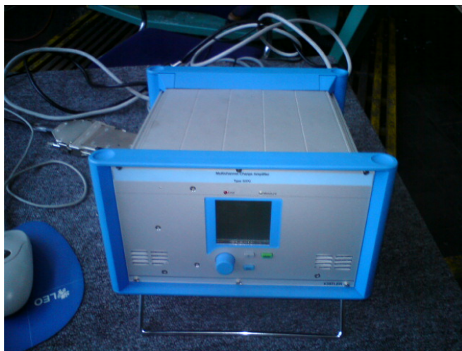
Obr. 4.4 Vícekanálový nábojový zesilovač
