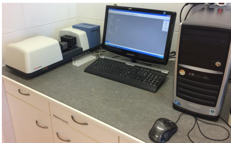
Obr. 9: UV-VIS spektrofotometr Specord S600 používaný pro měření všech spekter.
