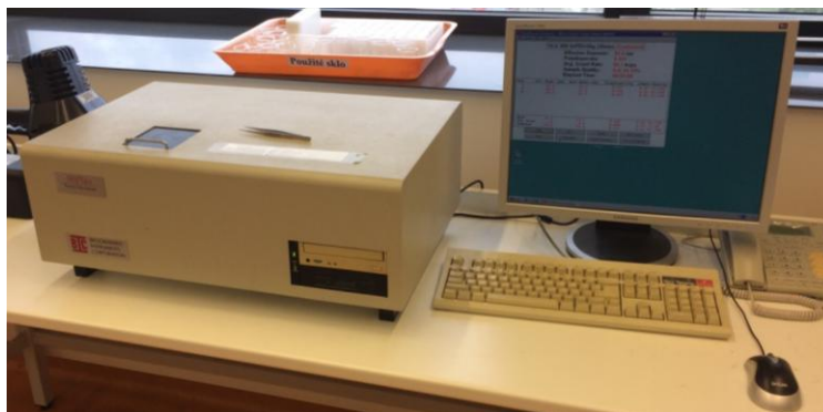
Obr. 8: Zeta Potencial Analyzer Zeta Plus (90Plus) používaný během všech experimentů.
