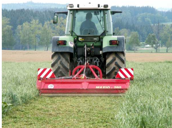
Obr. 35 Nesený kladívkový mulčovač, zdroj: (Agrostroj Pelhřimov a.s)
