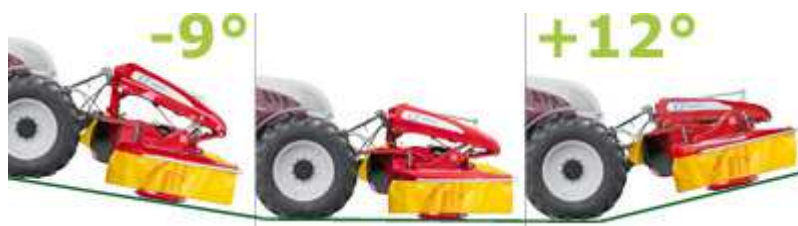
Obr. 26 Kopírování čelního ústrojí Pottinger, zdroj: (Pottinger)
