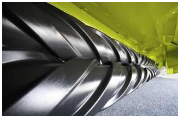
Obr. 38 Řešení válcového kondicionéru CLAAS, zdroj: (CLAAS)
