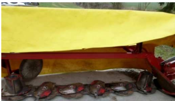
Obr. 4 Diskové žací ústrojí, zdroj:( autor)
