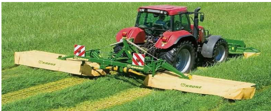
Obr. 31 Sečení píce při zapojení předního a obou zadních žacích ústrojí, zdroj: ( www.KRONE.de )
