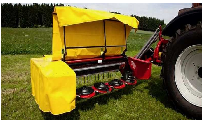
Obr. 5 Diskové žací ústrojí s čechračem, zdroj: (FELLA)
