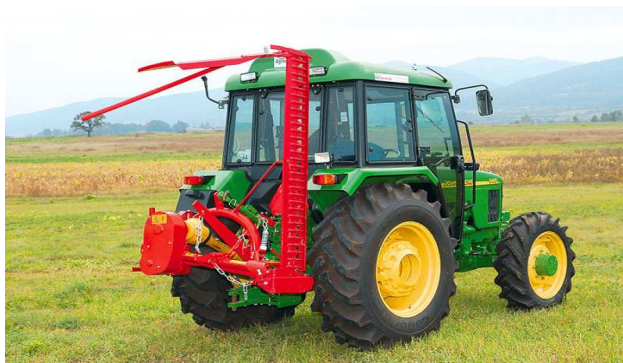
Obr. 2 Nesená prstová žací lišta, zdroj: (FPM AGROMECHANIKA)
