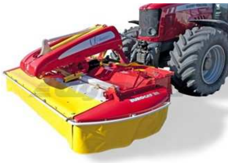
Obr. 24 Čelně nesený bubnový žací stroj Pottinger, zdroj: (Pottinger)
