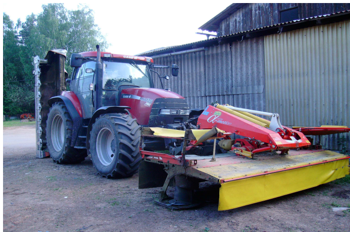
Obr. 30 Zapojení předního a zadního diskového žacího stroje, zdroj: (autor)
