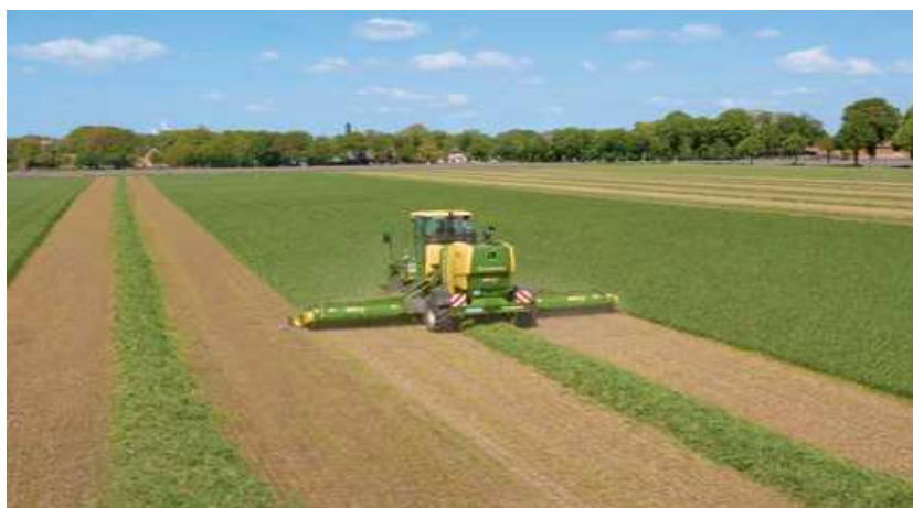
Obr. 40 Samojízdní žací mačkač BIG M 500, zdroj: (KRONE)
