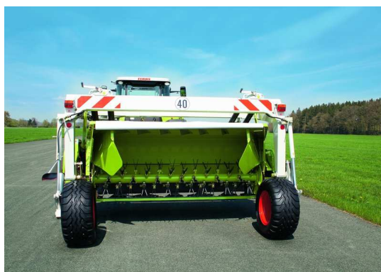
Obr. 37 Prstový kondicionér výrobce CLAAS, zdroj:( CLAAS)
