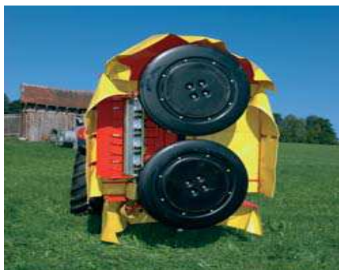
Obr. 22 Bubnové žací ústrojí nožové FELLA, zdroj: (FELLA)
