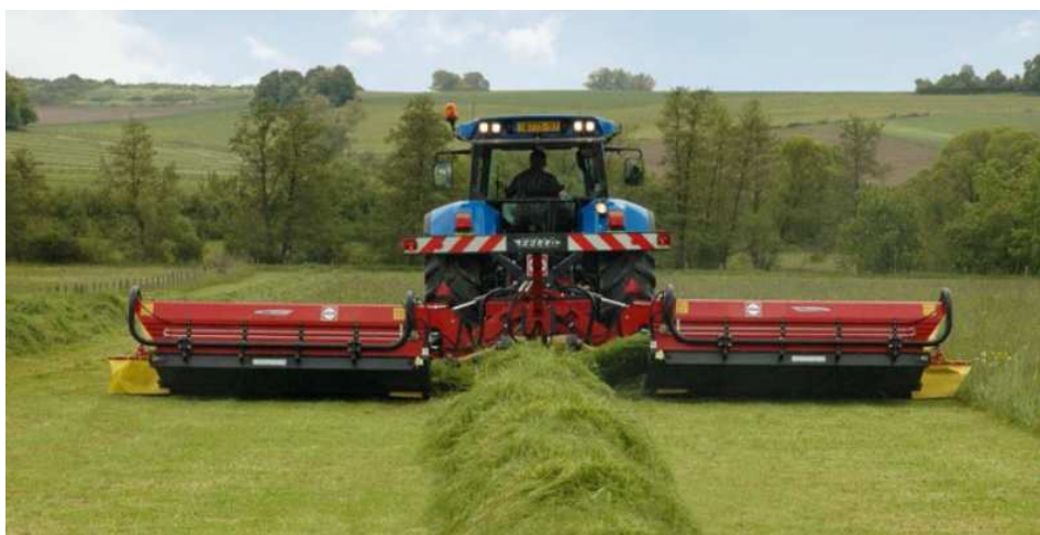
Obr. 39 Žací ústrojí s překládáním do řádků FELLA, zdroj: (FELLA)
