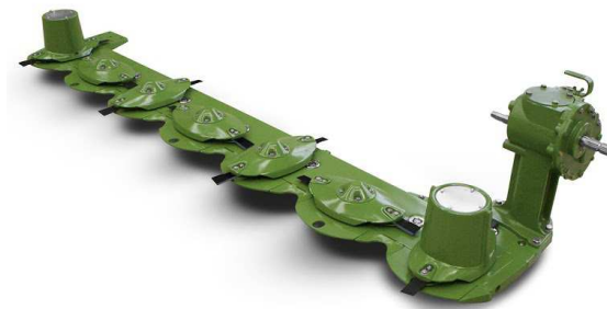
Obr. 29 Řešení pohonu diskového ústrojí KRONE, zdroj:( www.KRONE.de )
