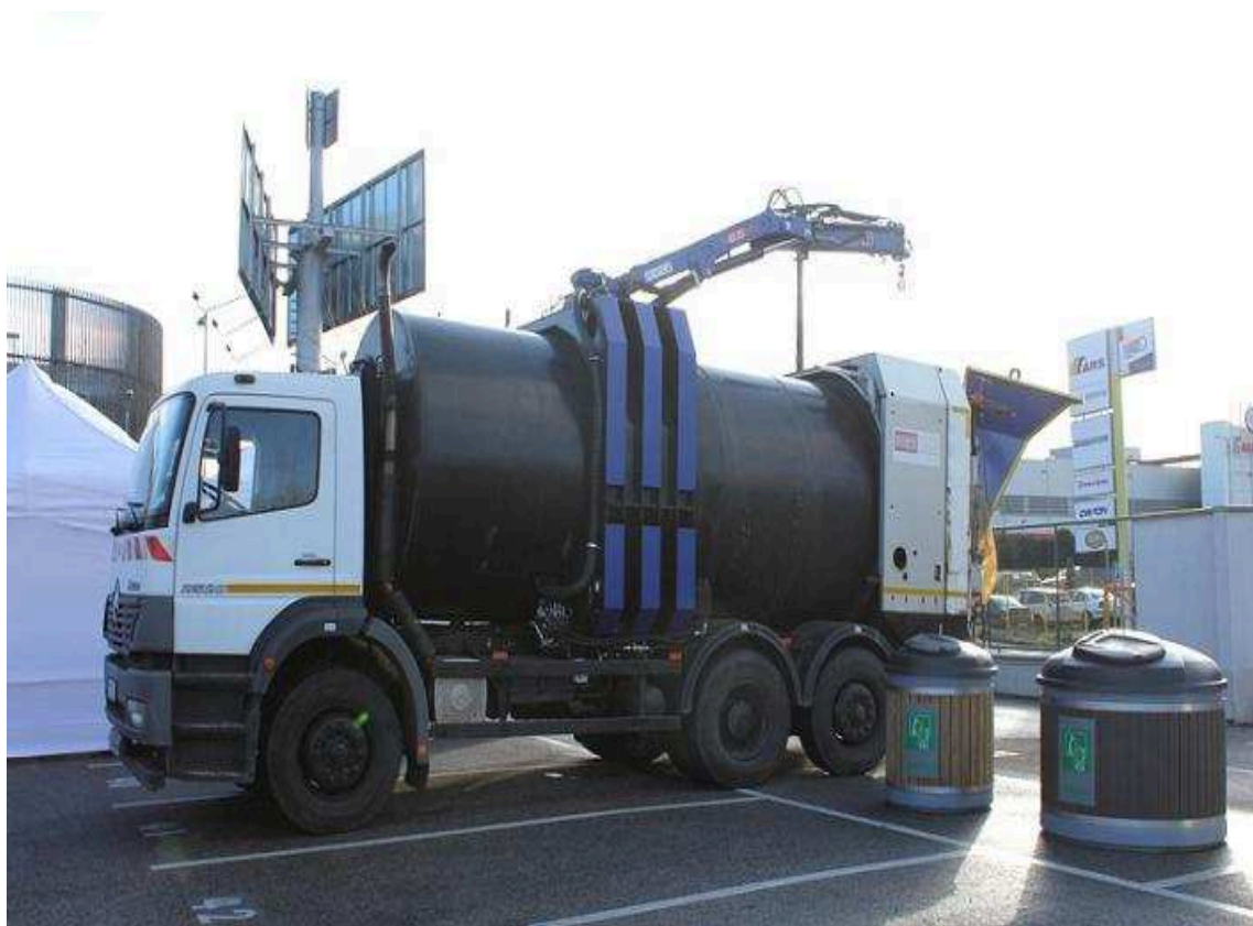
Obr. 3.1 Svoz odpadu z polopodzemních kontejnerů v Trnavě
