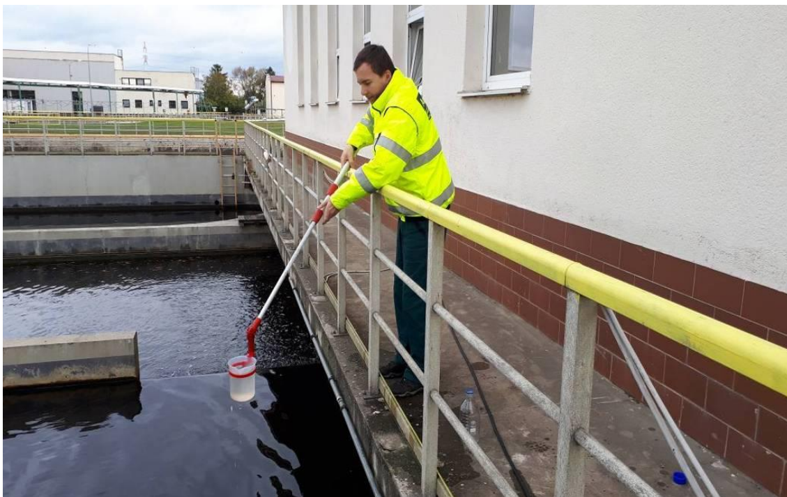
Obr. 39 Odebírání odpadní vody před začátkem pokusu z nádrže u objektu chlorovny
