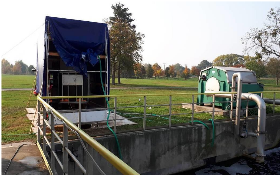
Obr. 38 Jednotka AOP během testování
