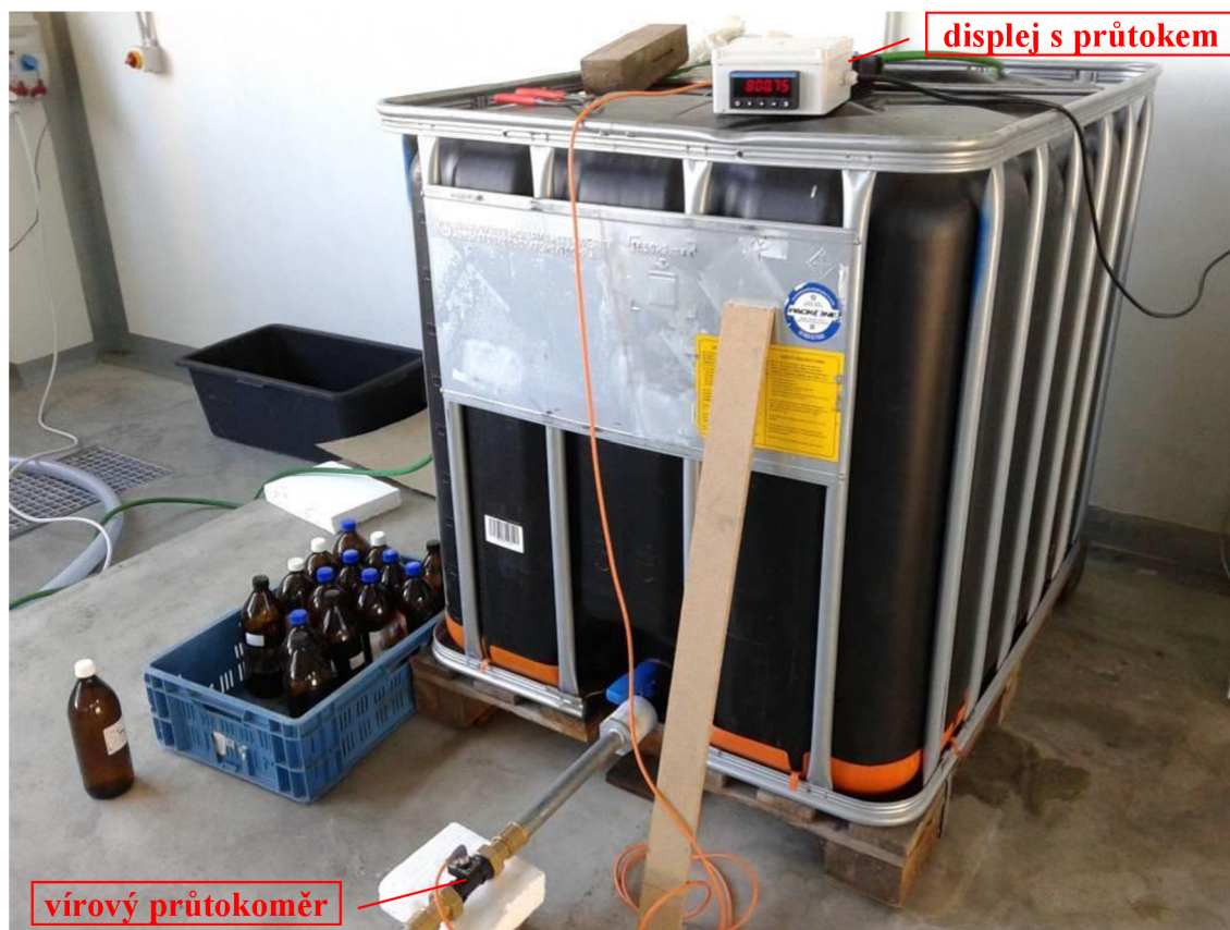
Obr. 25 Pohled na velkokapacitní nádrž o objemu 1000 litrů a vírový průtokoměr s displejem
