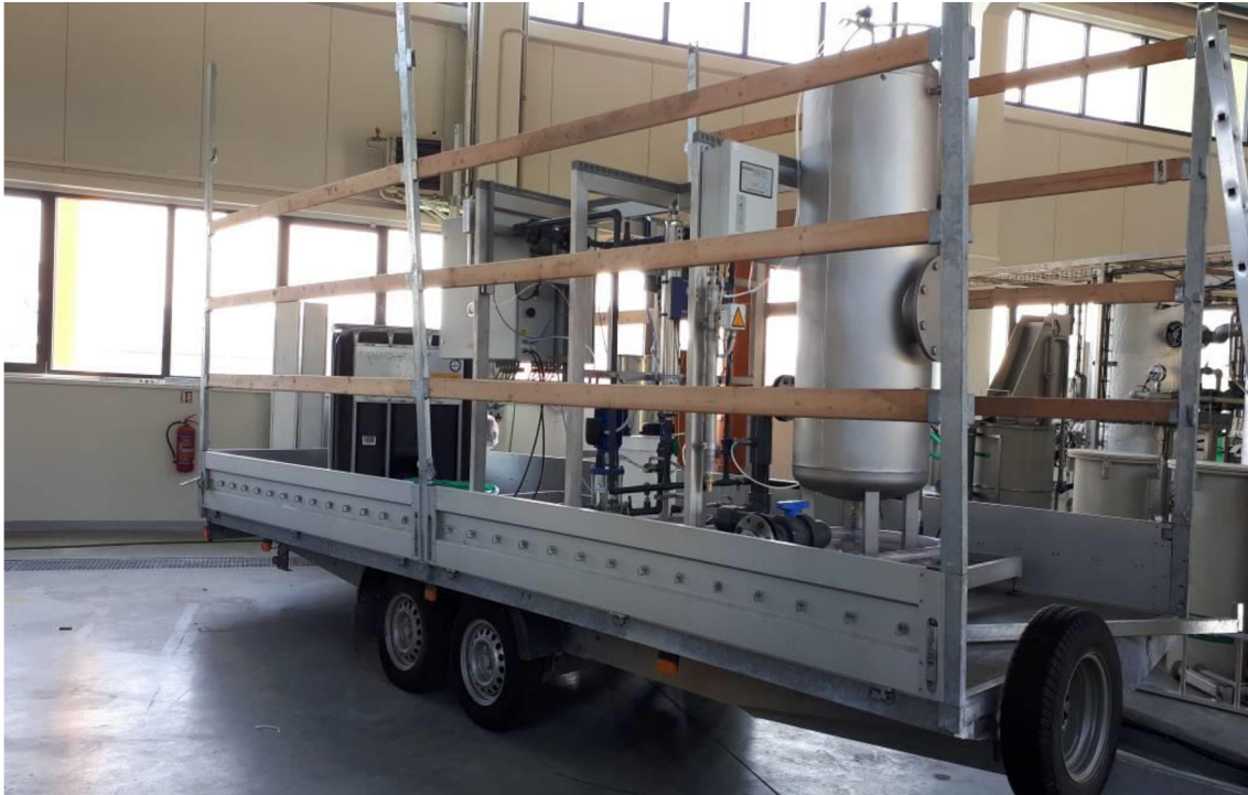
Obr. 34 Pohled na naloženou jednotku AOP na dvounápravovém přívěsu v hale P4 Vědeckého centra AdMaS
