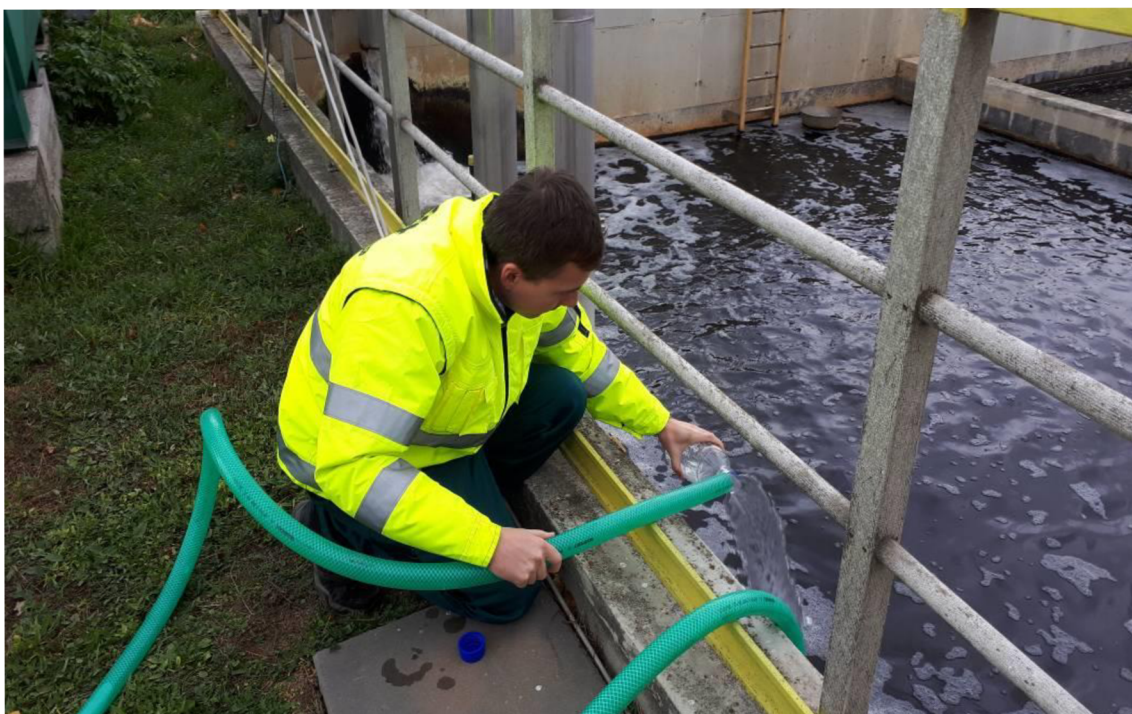
Obr. 40 Odebírání odpadní vody na odtoku z jednotky AOP zpět do nádrže
