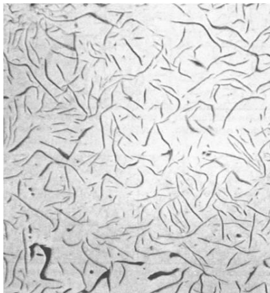
Obrázek 3.1 – Mikrostruktura šedé litiny (Metal Casting Institute, 2022)
