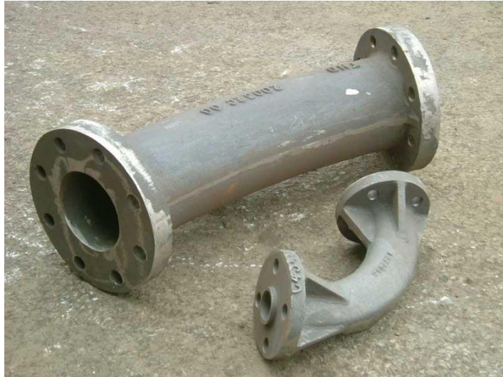
Obrázek 4.6 – Příklad odlitku z bílé litiny (Metallurgy, 2022)
