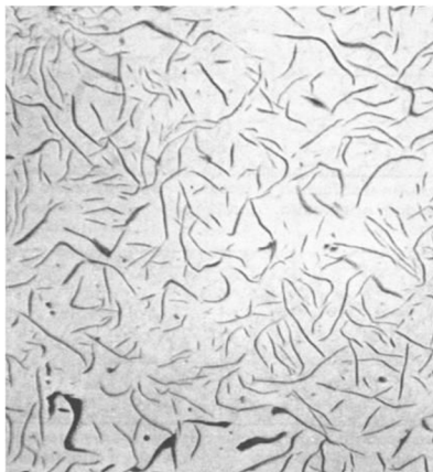
Obrázek 3.1 – Mikrostruktura šedé litiny (Metal Casting Institute, 2022)
