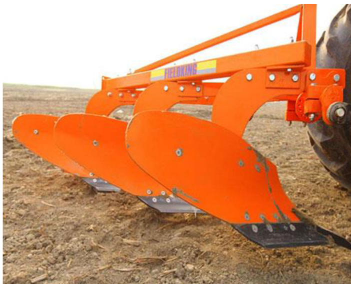
Obrázek 4.3 - Litinový pluh používaný v zemědělství (Fieldking, 2022)
