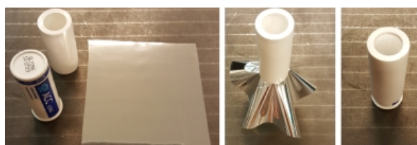
Obrázek 42 | Fotografie postupné přípravy vzorku. Vlevo připravené tuby se vzorkem. Uprostřed začátek nasouvání na tubu a vpravo připravený vzorek.
