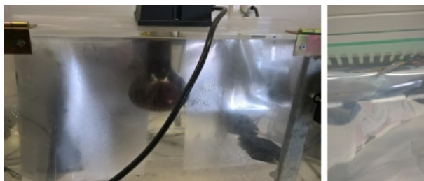
Obrázek 56 | Fotografie průběhu zátěžového testu zvýšené vlhkosti vlevo. Vpravo ukázka uchycení.
