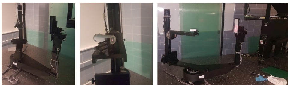
Obrázek 46 | Fotografie připraveného měření rozptylu. Vlevo pohled na celý systém, uprostřed detail na vzorek, vpravo pohled na celý systém z druhé strany včetně zdrojového laseru.
