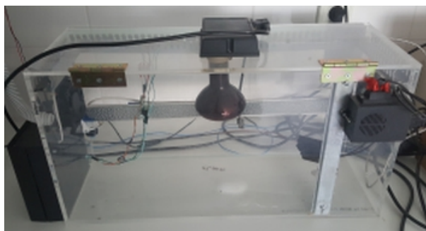
Obrázek 51 | Fotografie klimatické komory, ve které probíhaly zátěžové testy.
