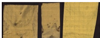
Obrázek 48 | Ukázka kontroly před měřením. Vhodná jsou pouze místa s plynulou vrstvou lepidla a bez vzduchových bublin.
