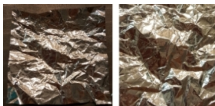
Obrázek 52 | Fotografie poničené fólie pro měření spektrální odraznosti. Vlevo celý vzorek, vpravo detail.
