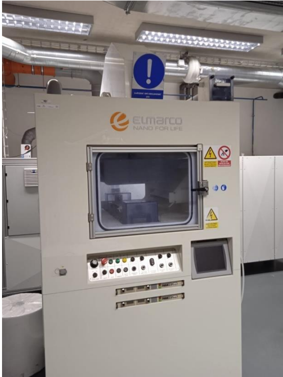
Obrázek 12a: Zařízení Nanospider v předu s klimatizační jednotkou v pozadí
