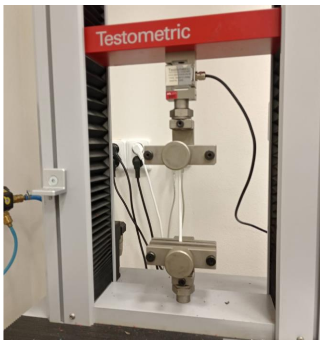
Obrázek 26: Upnutí vzorku do přístroje Testometric M350-5CT
