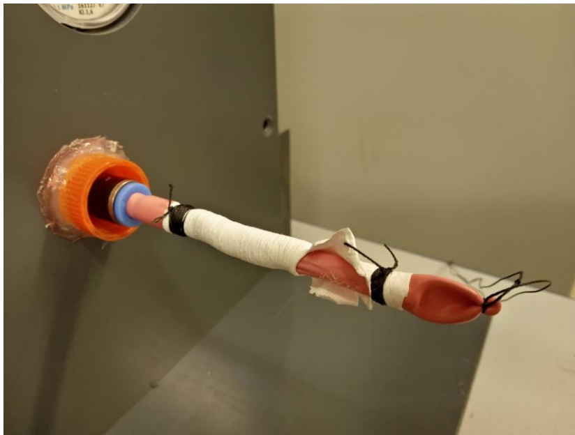
Obrázek 27: Upevněný roztržený vzorek po testu
