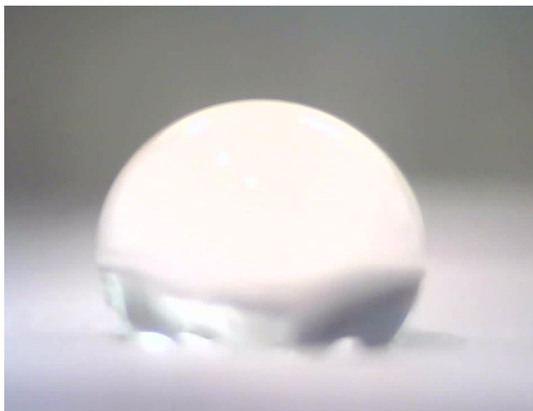
Obrázek 21: Snímek kapky pro měření kontaktního úhlu
