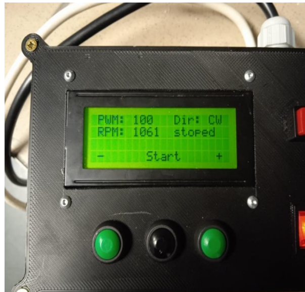
Obrázek 14: Řídící jednotka tubulárního kolektoru
