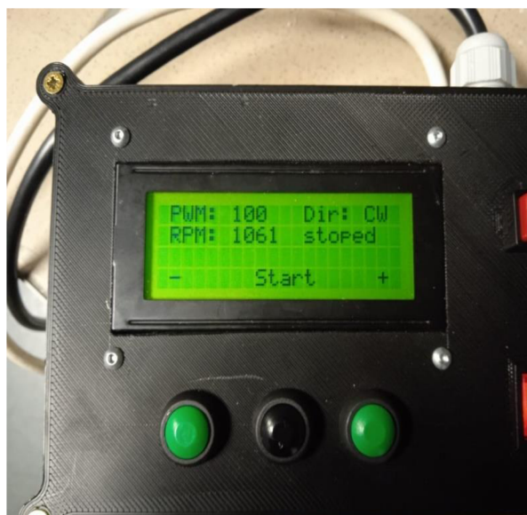
Obrázek 14: Řídící jednotka tubulárního kolektoru
