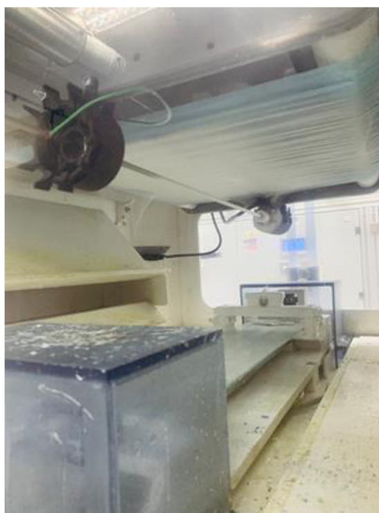
Obrázek 12b: Zvlákňovací komora zařízení Nanospider s implementovaným cévstrojem
