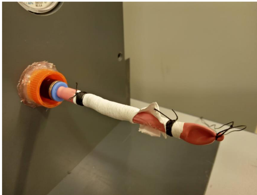
Obrázek 27: Upevněný roztržený vzorek po testu
