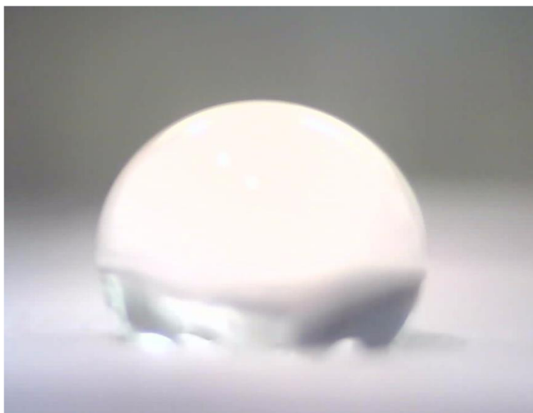
Obrázek 21: Snímek kapky pro měření kontaktního úhlu
