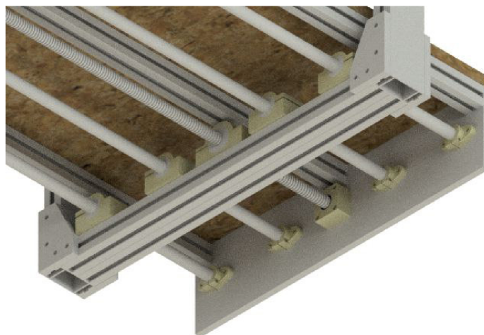
Obr. 27: Osazení osy Y na čtyřech válcových tyčích
