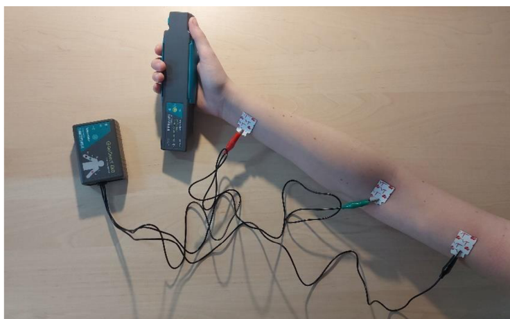
Obrázek 24: Správné nalepení elektrod a připojení krokodýlků čidla EMG (vlastní práce autorky)
