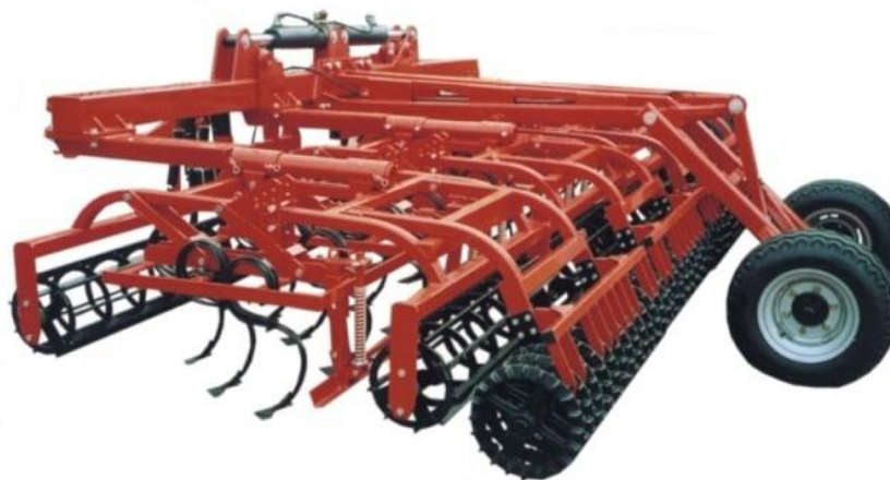
Obrázek 3. Kombinátor WICHER pro přípravu seťového lůžka (Zdroj: http://www.utilaje-agricole-wirax.com/ ).
