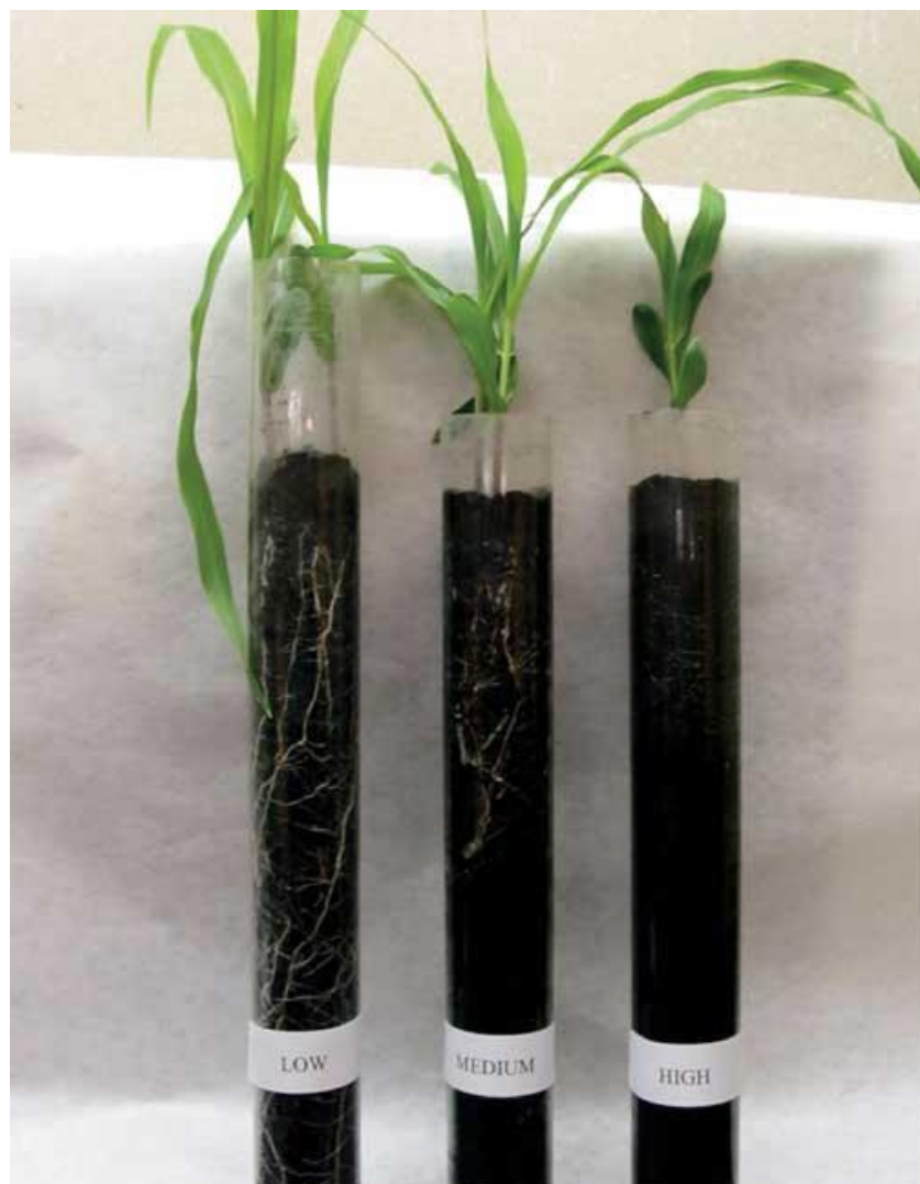
Obrázek 1. Dopad zhutnění na růst kořenového systému. Vlevo objemová hmotnost 0,7 \text{ g.cm}^{-3} , uprostřed 1,1 \text{ g.cm}^{-3} , vpravo 1,6 \text{ g.cm}^{-3} . (Zdroj: http://www.ipm.iastate.edu/ )
