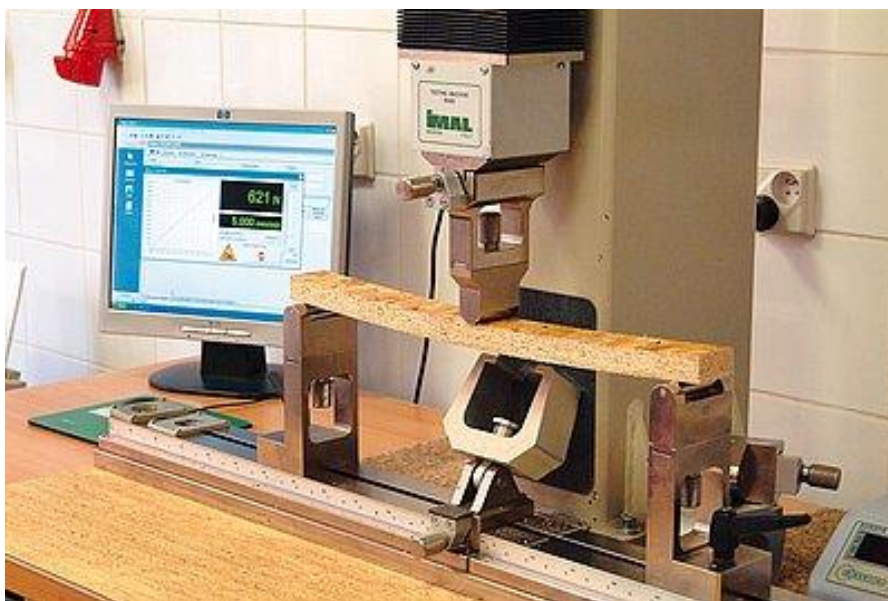
Obr. 7 Zkouška ohybu v laboratoři firmy Kronospan (zdroj: www.stavebnictvi3000.cz )
