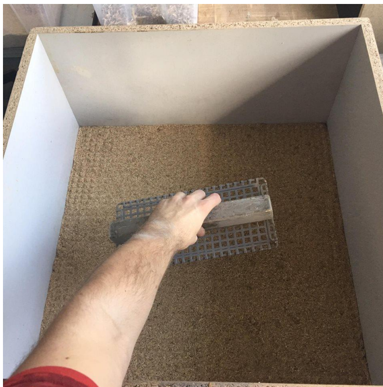
Obr. 27 Vrstvení třískového koberce do formy
