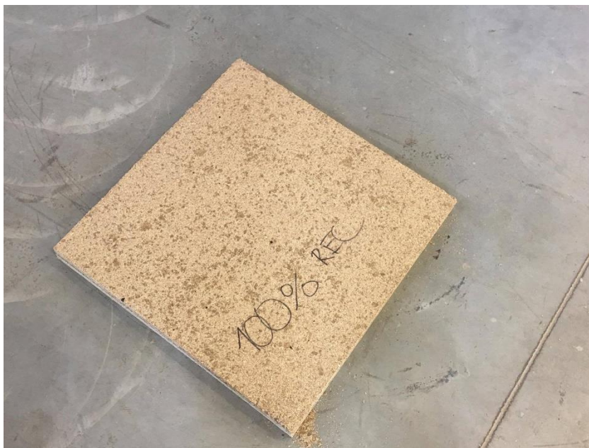
Obr. 80 Vylisovaná deska s viditelnými skvrnami od lepidla
