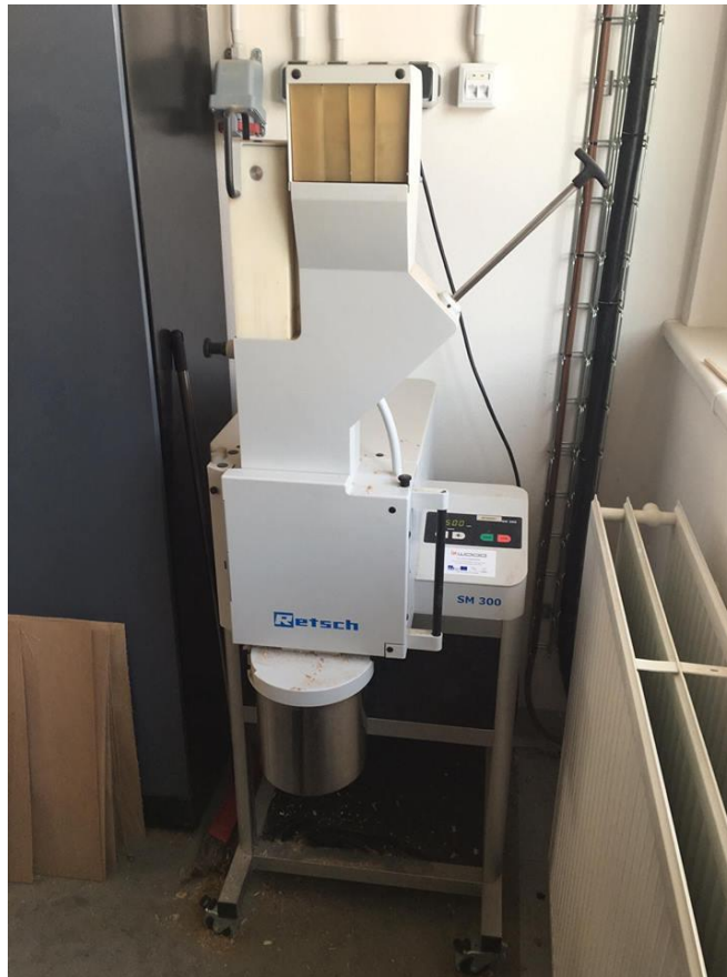
Obr. 19 Laboratorní mlýn Retsch SM 300
