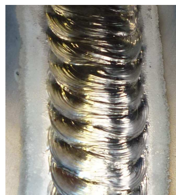
Obrázek 54 Třetí vrstva svaru, strojní svařování, vlastní zdroj
