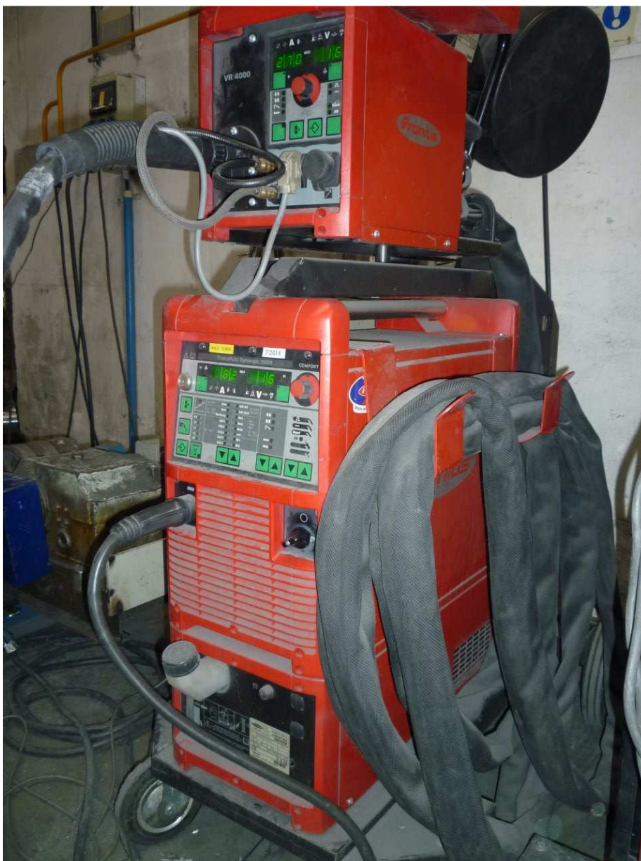
Obrázek 26 Svařovací digitální zdroj pro svařování hliníku a jeho slitin od firmy FRONIUS, typ TranPuls Synergic 5000, vlastní zdroj
