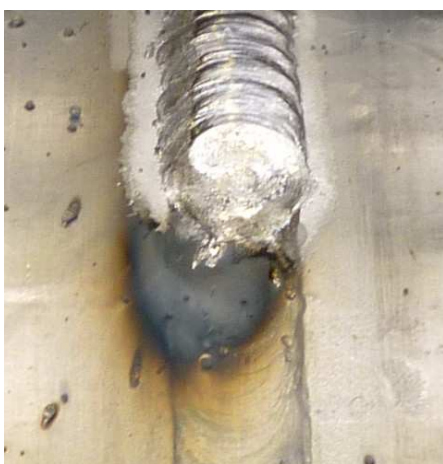
Obrázek 51 Druhá a třetí vrstva svaru, vlastní zdroj
