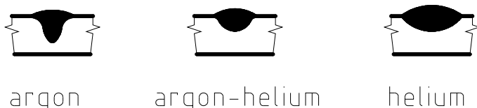
Obrázek 39 Rozdílnost závaru při použití ochranného plynu Ar a He, převzato a upraveno z [3]
