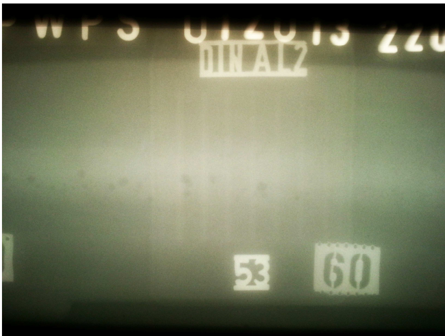
Obrázek 60 Rentgenový snímek s póry (tmavé tečky), vlastní zdroj
