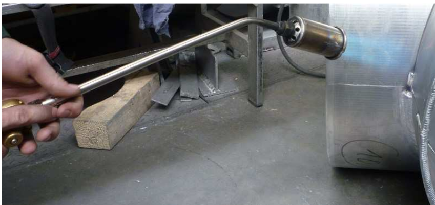
Obrázek 23 Nahřívání vodiče propan-butanovým plamenem, vlastní zdroj
