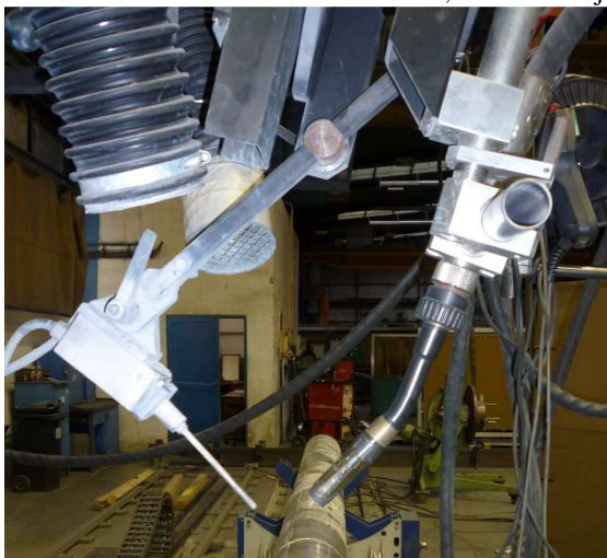
Obrázek 44 Pendl (vlevo) a hořák svařovacího automatu, vlastní zdroj
