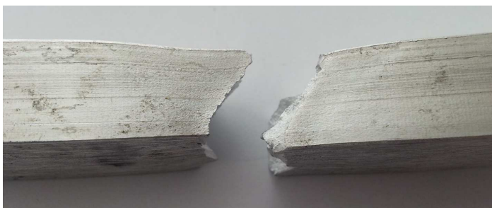
Obrázek 58 Vzorek po zkoušce tahem, vlastní zdroj
