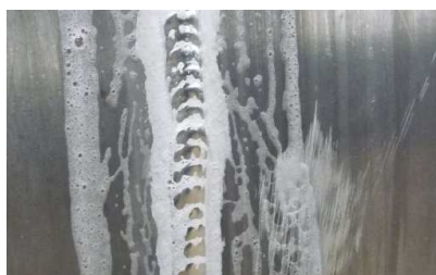
Obrázek 47 Zkouška tlakem-svár s vrstvou mýdlového roztoku, vlastní zdroj
