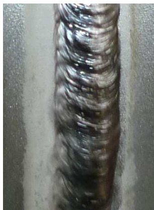
Obrázek 53 Druhá vrstva svaru, strojní svařování, vlastní zdroj
