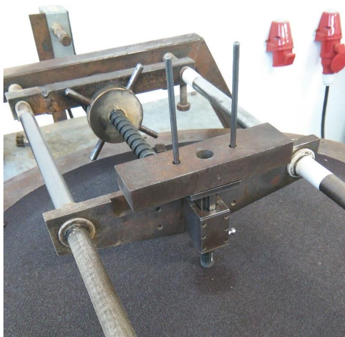
Obr. 30 Detail upínací hlavice se závažím
