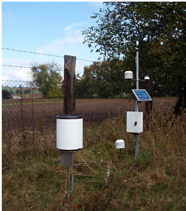
Obr. 3 Meteorologická stanice BYST (foto: M. Lehnert)
